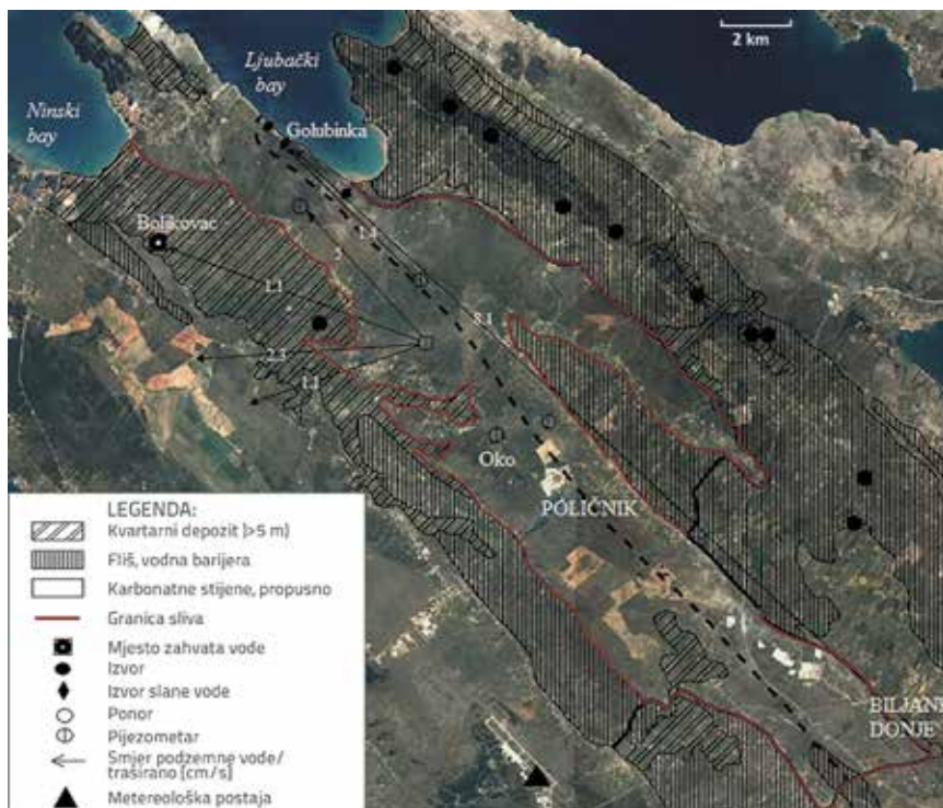
Slika 1. Shematska hidrogeološka karta slivnog područja izvora Golubinka
