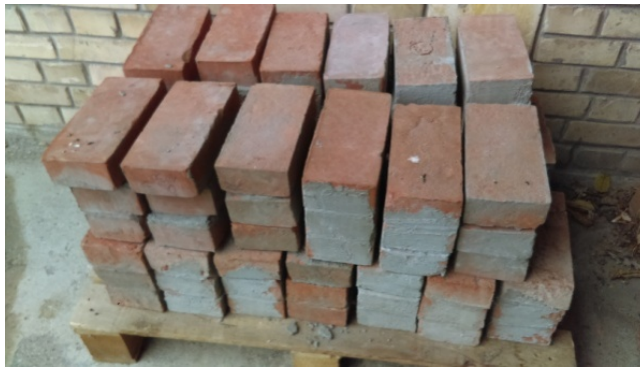
Slika 6.1. Ispitni uzorci nakon izlaganja ciklusima smrzavanja i odmrzavanja
