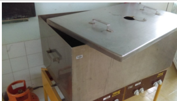
Slika 5.23. Ispitivanje vodoupojnosti kuhanjem zidnih elemenata
