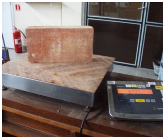
Slika 3.7 Vaganje opeke "na zraku"
