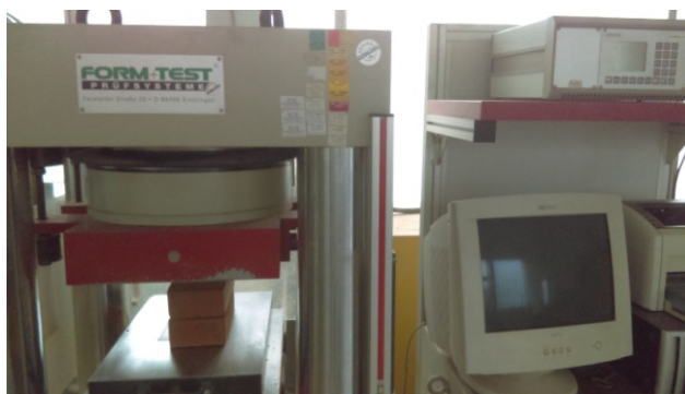
Slika 5.21. Određivanje tlačne čvrstoće zidnih elemenata
