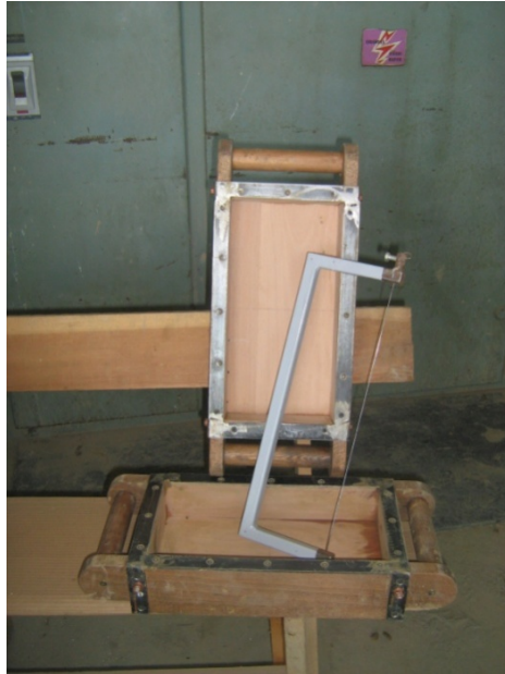
Slika 3.15 Drveni kalup za oblikovanje ručno proizvedene opeke
