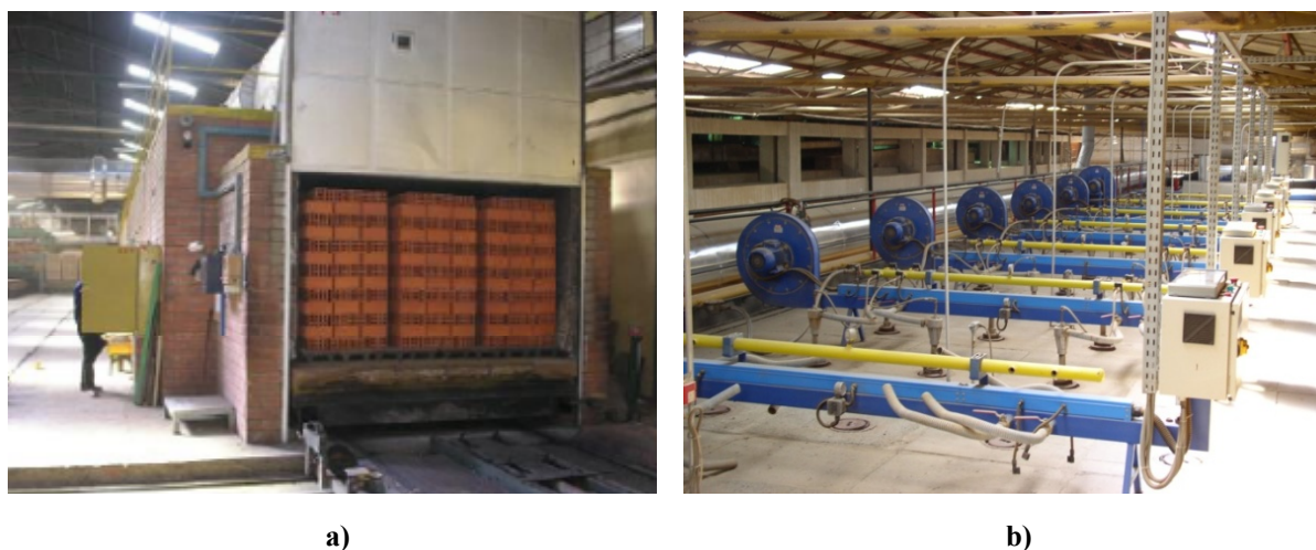
Slika 3.23 Pogon Našice: a) tunelska peć; b) stropni plamenici
