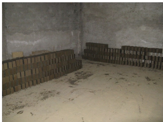
Slika 5.7. Uzorci kontrolirane proizvodnje: a) serija opeka proizvedenih strojno; b) serija opeka proizvedenih ručno
