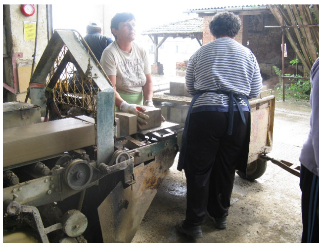
Slika 5.5. Strojna izrada opeka
