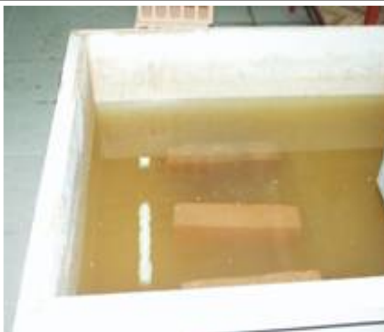
Slika 3.9 Ispitivanje vodoupojnosti opeke
