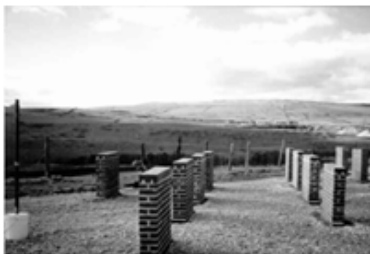
Slika 4.6 Ispitivanje zidnih panela na terenu [184]
