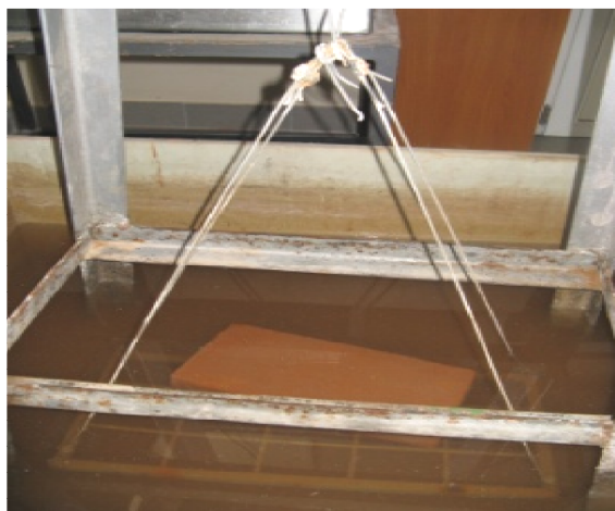
Slika 3.6 Hidrostatsko vaganje opeke
