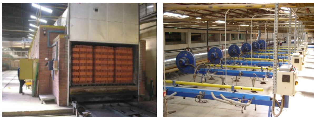
Slika 3.23 Pogon Našice: a) tunelska peć; b) stropni plamenici
