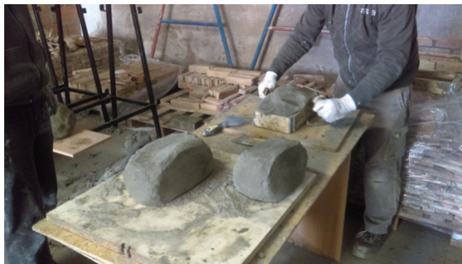
Slika 5.6. Ručna izrada opeka
