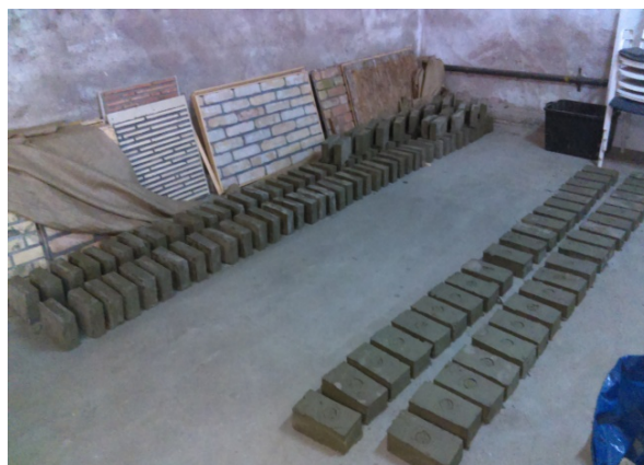
Slika 5.7. Uzorci kontrolirane proizvodnje: a) serija opeka proizvedenih strojno; b) serija opeka proizvedenih ručno
