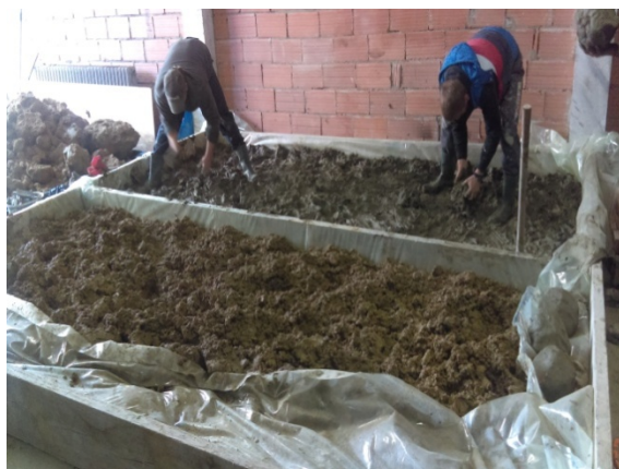
Slika 5.8. Sirovine za kontroliranu proizvodnju: a) boja sirovine kao rezultat sadržaja karbonata; b) boja nepečene opeke kao rezultat sirovine
