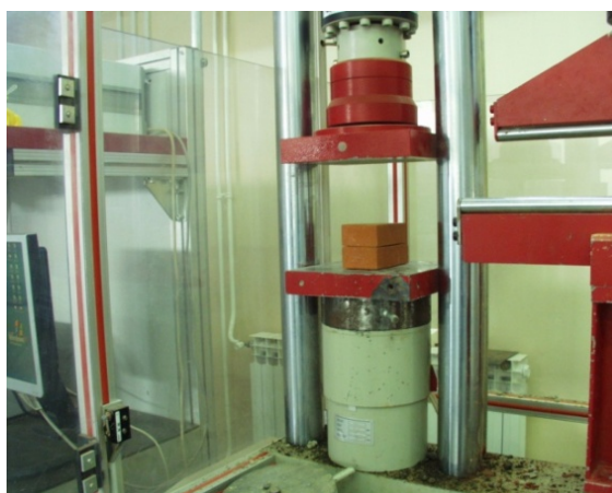
Slika 3.11 Određivanje tlačne čvrstoće u preši
