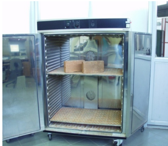
Slika 3.8 Sušenje uzoraka u sušioniku
