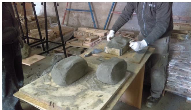
Slika 5.6. Ručna izrada opeka
