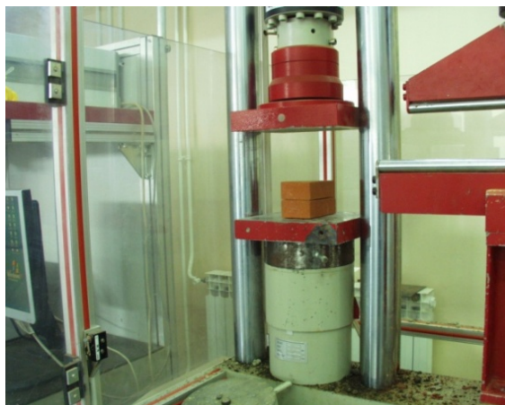
Slika 3.11 Određivanje tlačne čvrstoće u preši
