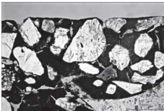
Slika 4.4 Prikaz uzorka srednjovjekovnog morta pod mikroskopom [140]
