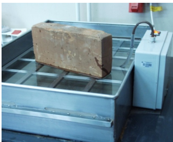
Slika 5.24. Određivanje kapilarne vodoupojnosti zidnih elemenata
