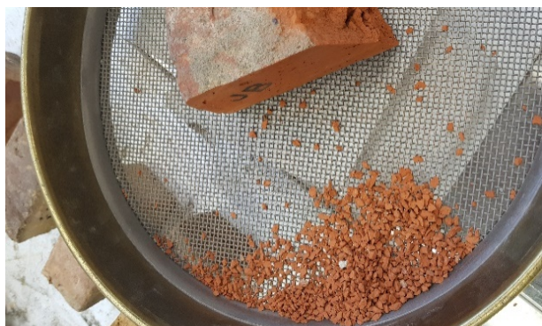
Slika 5.28 Izgled uzorka pripremljenog za BET uređaj Građevinskog i arhitektonskog fakultetu Osijeku: a) priprema uzorka prosijavanjem na sitima, b) konačan izgled sipitnog uzorka
