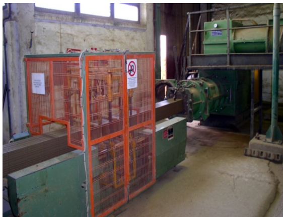
Slika 3.14 Vakumski agregat i rezaći stol
