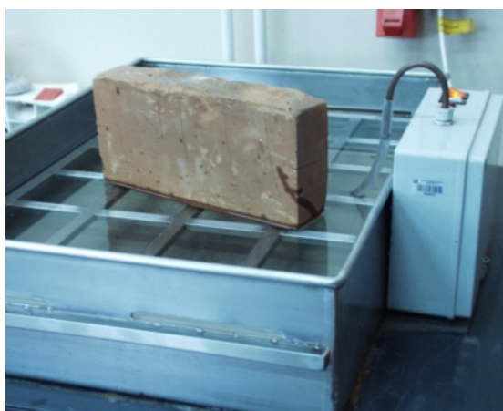
Slika 3.10 Ispitivanje početnog kapilarnog upijanja
