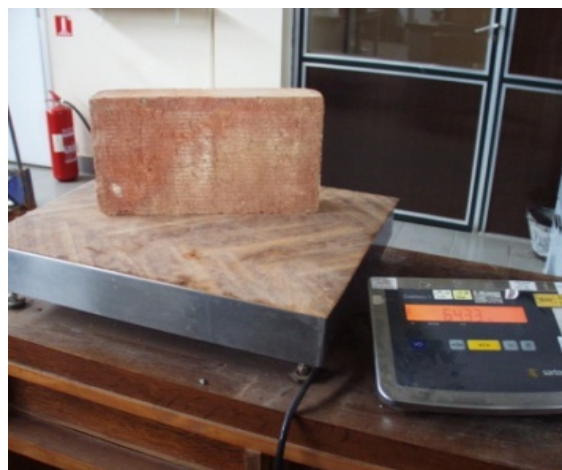
Slika 3.7 Vaganje opeke "na zraku"
