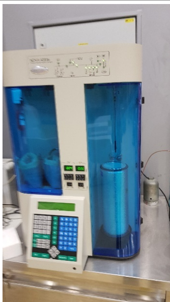
Slika 5.27. Prikaz BET uređaja sa Građevinskom i arhitektonskom fakultetu u Osijeku: a) izgled BET uređaja, b) uzorci opeke u epruvetama BET uređaj
