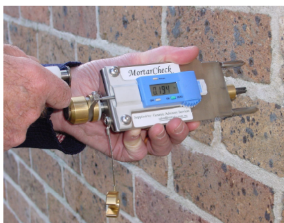
Slika 4.7 Mjerenje indeksa abrazije in situ [186, 187, 189]
