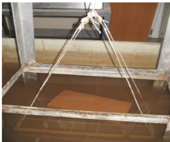
Slika 3.6 Hidrostatsko vaganje opeke
