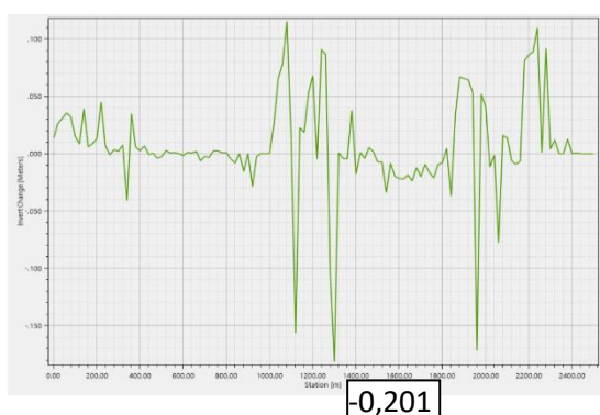
Slika 6.7. Promjena visine dna kanala nakon 120 h
