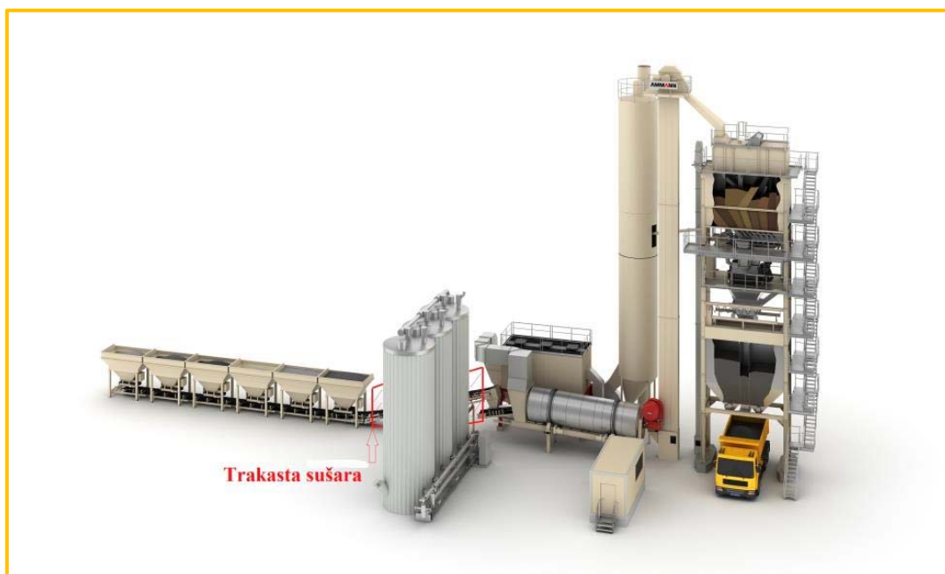
Slika 7-21: Shematski prikaz smještaja trakaste sušare na asfaltnoj bazi (umjesto kose trake) [44]
