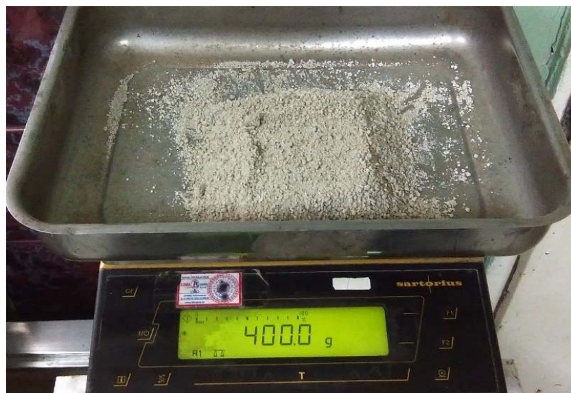
Slika 6-9: Određivanje mase uzorka prije ispitivanja vaganjem
