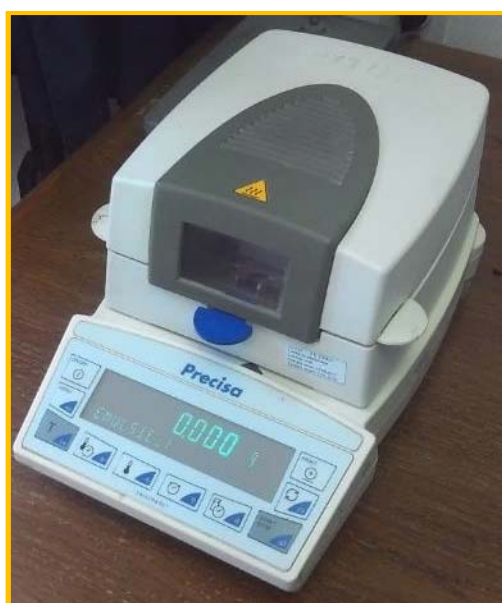
Slika 6-25: Uređaj za ispitivanje vlažnosti
