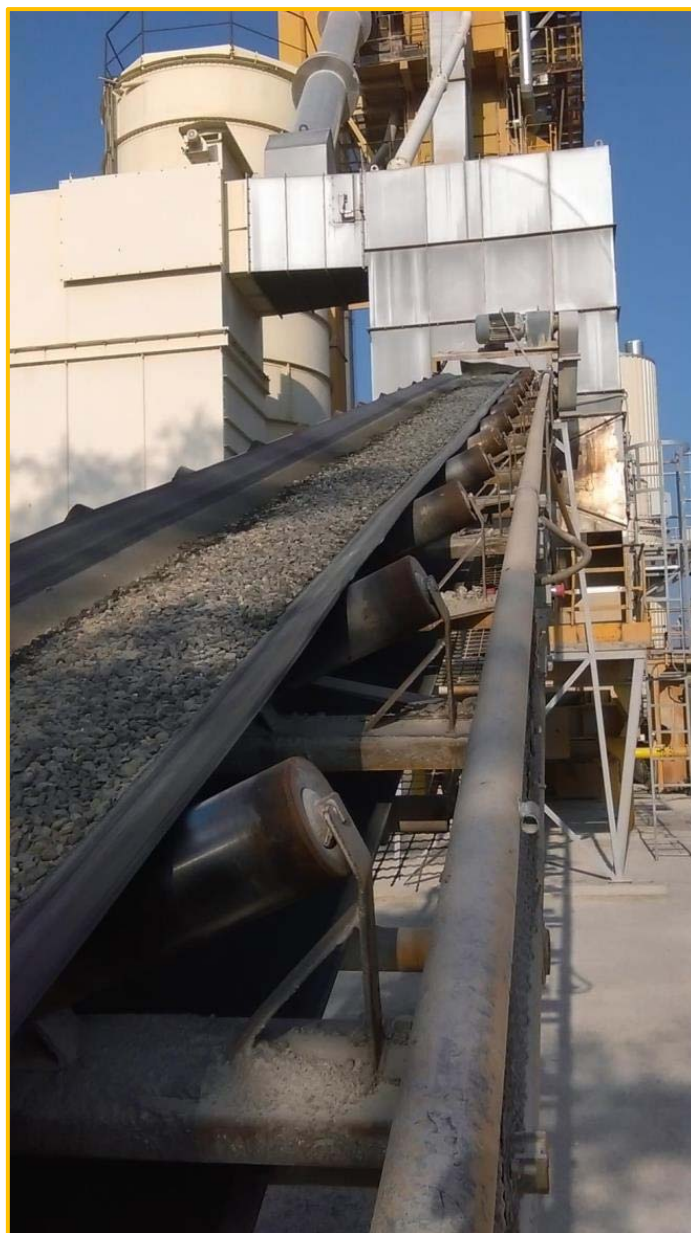
Slika 7-20: Kosa transportna traka na asfaltnoj bazi
