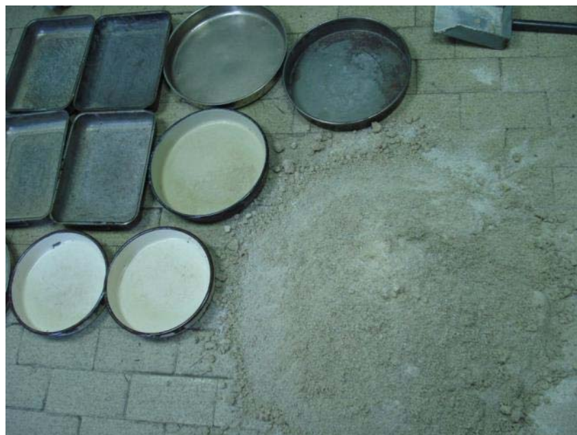
Slika 6-6: Homogenizirani i pripremljeni uzorak za ispitivanje
