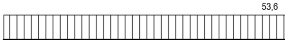
Dijagram uzdužnih sila, N_{Ed} [kN]
