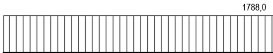
Dijagram uzdužnih sila, N_{Ed} [kN]
