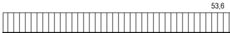
Dijagram poprečnih sila, V_{z,Ed} [kN]
