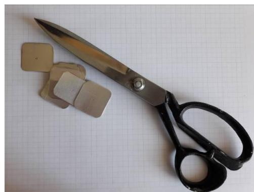
Slika 14. Blende za kameru načinjene od tankog aluminija
