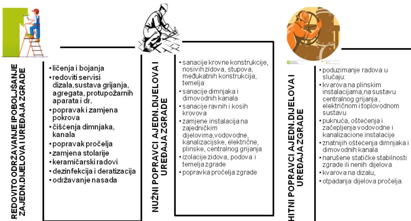
Slika 2: Vrste radova na održavanju zajedničkih dijelova zgrada prema Uredbi [2]
