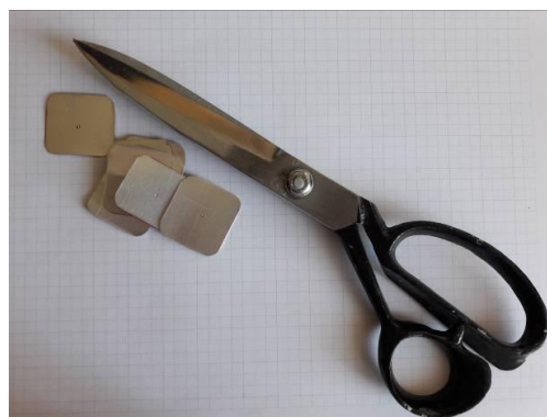
Slika 14. Blende za kameru načinjene od tankog aluminijske folije
