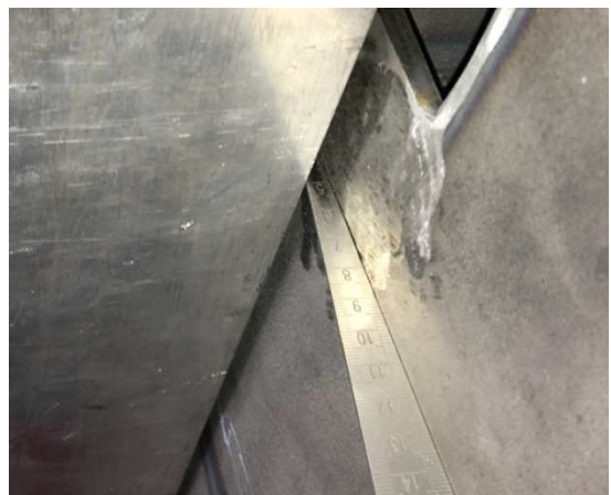
Slika 6. Stub zavaren izvan alata
