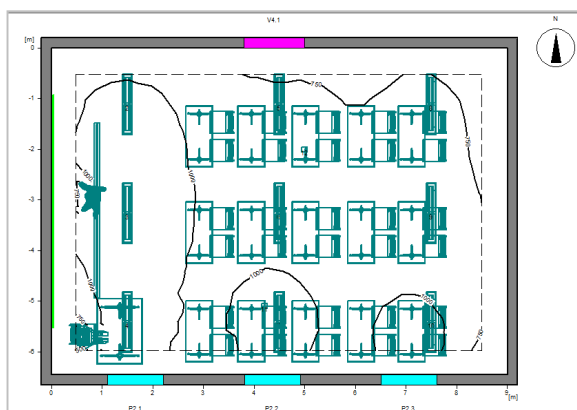
Slika 2. Proračun rasvjete u Relux-u – prikaz izoluxs krivulja
