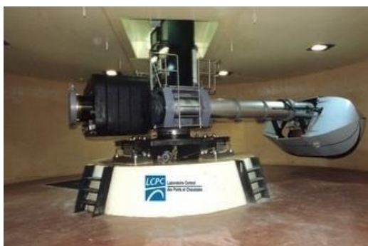
Slika 97. Gredne geotehničke centrifuge: u laboratoriju IFSTTAR ( lijevo ) i na Sveučilištu Dundee ( desno )
