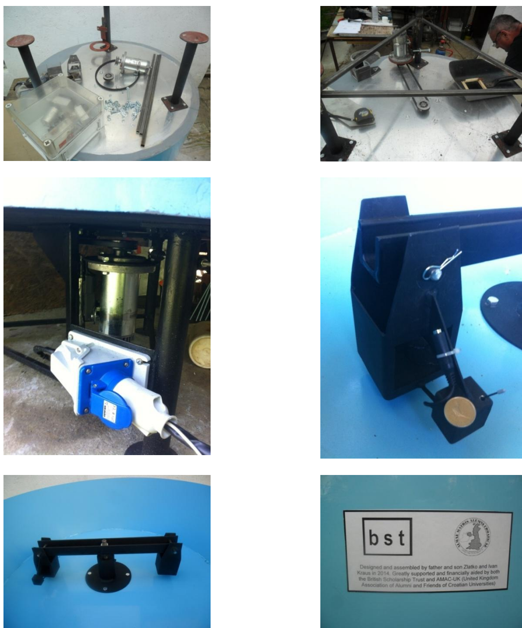
Slika 182. Kratki prikaz dijelova male geotehničke centrifuge i tjeka njene izrade
