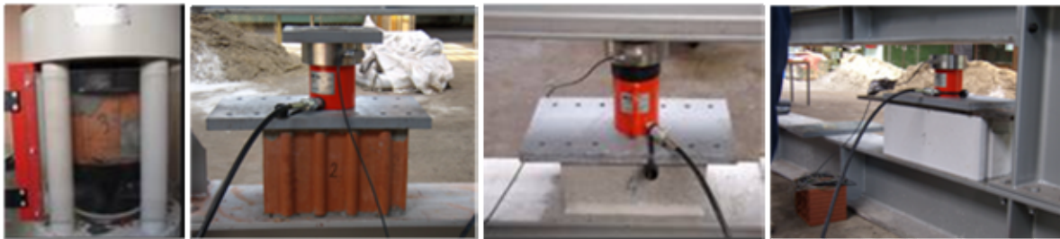
Slika 3.2 Ispitivanje tlačne čvrstoće blok opeke, euroterma, betonskog bloka i ytonga
