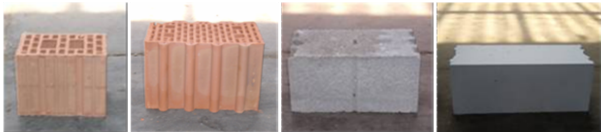
Slika 3.1 Blok opeka, euroterm, betonski blok i ytong
