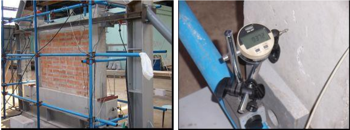
Slika 4.18 Prikaz mikroure za kontrolu klizanja na modelima (GRUPAMA)
