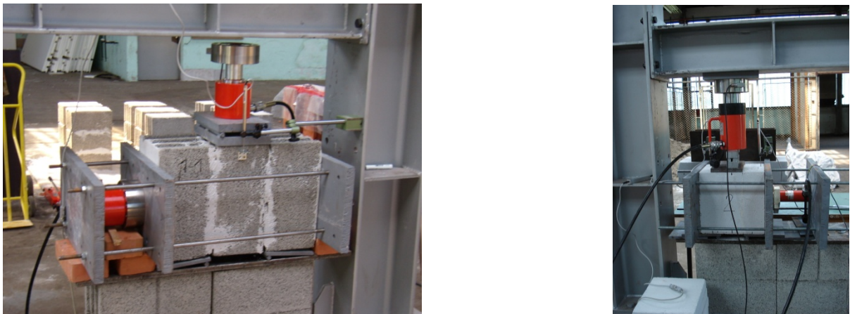
Slika 3.27 Ispitivanje posmične čvrstoće zidnog ispuna od betonskog bloka i ytonga
