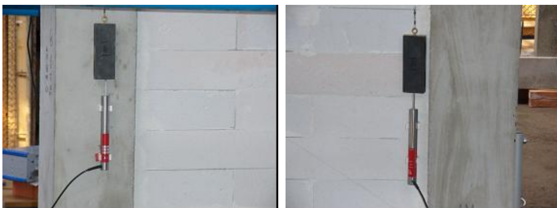
Slika 4.15 Prikaz LVDT_a za mjerenje produljenja odnosno skraćenja dijagonala
