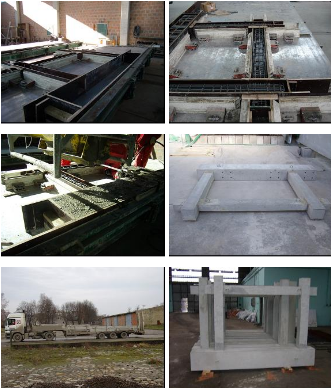
Slika 4.3 Prikaz izrade i dopreme armirano-betonskih okvira modela
