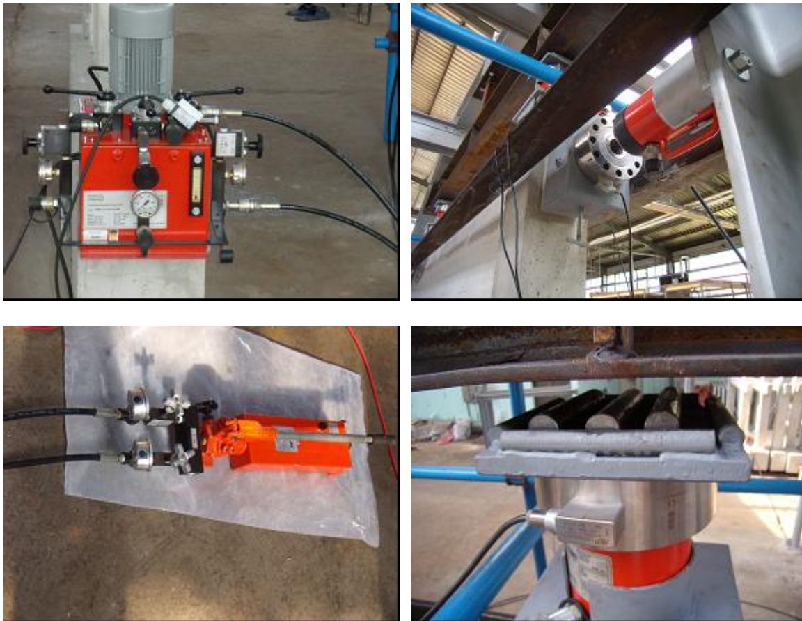
Slika 4.13 Prikaz instrumenata za unos horizontalne i vertikalne sile
