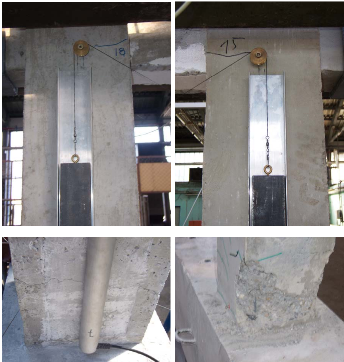
Slika 4.42 Prikaz pukotina na MODELU 10
