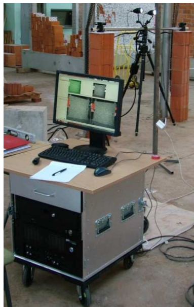
Slika 6.2 Prikaz mjernog optičkog sustava ARAMIS
