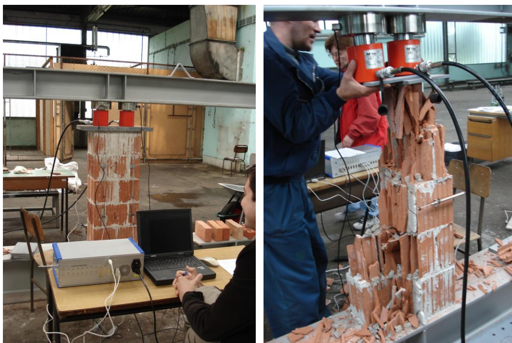
Slika 3.4. Ispitivanje tlačne čvrstoće zida
