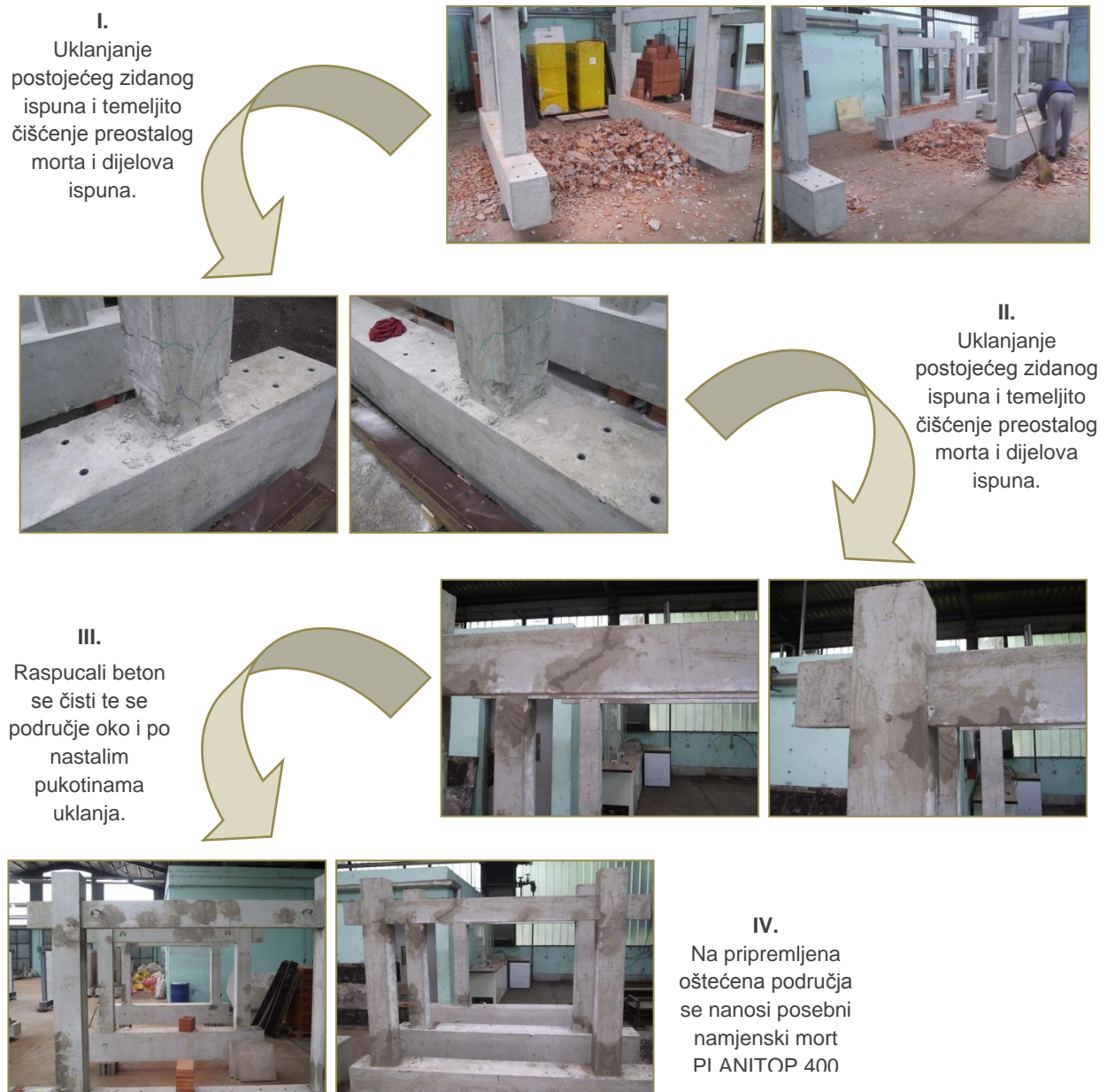
Slika 2.22. Redoslijed postupaka pri pripremi armirano-betonskih okvira uzoraka
