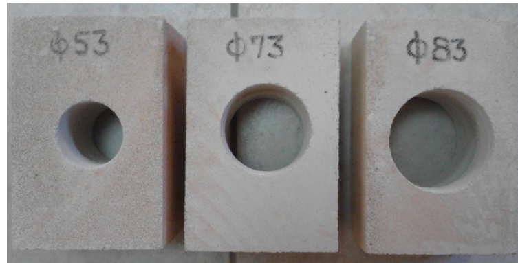
Slika 4.7 – Izbušeni porobetonski blokovi
