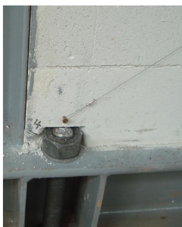
Slika 4.32 - Mjerenje produljenja/skraćenja dijagonala zidanog ispuna
