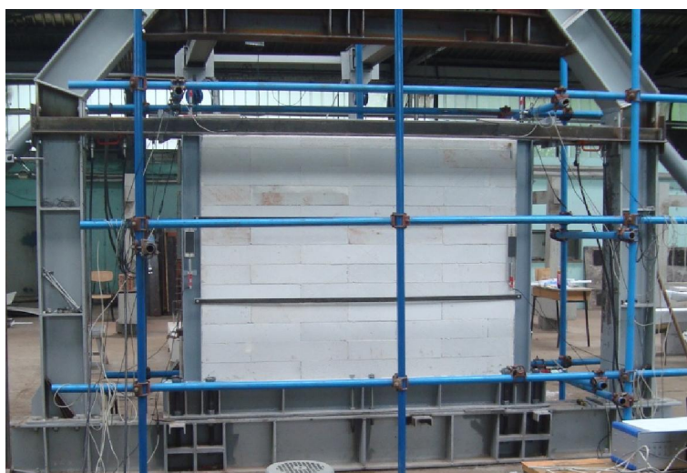
Slika 4.36 - Ispitivanje čeličnog okvira sa zidanim ispunom od porobetonskih blokova (OY-i)
