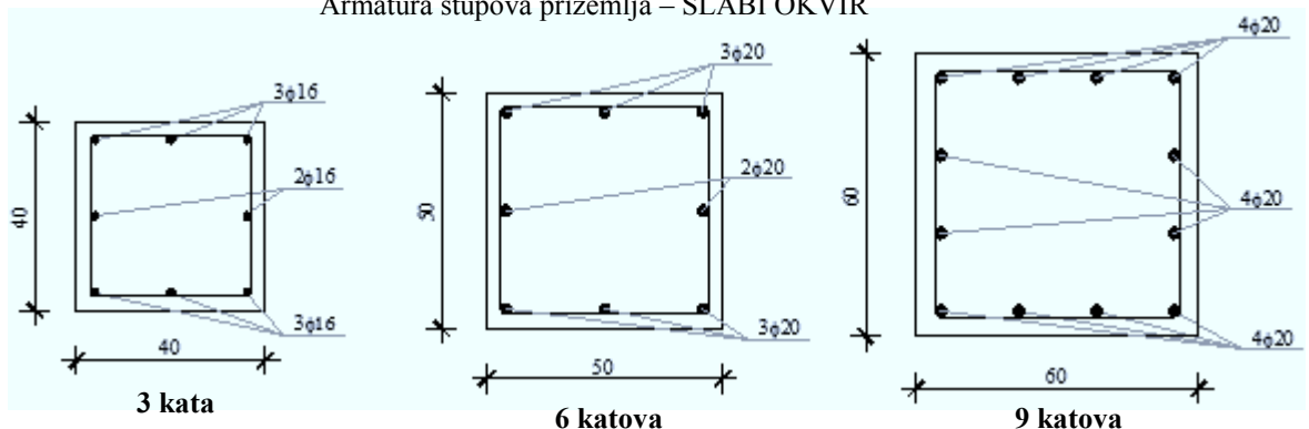
Armatura stupova prizemlja – SLABI OKVIR
