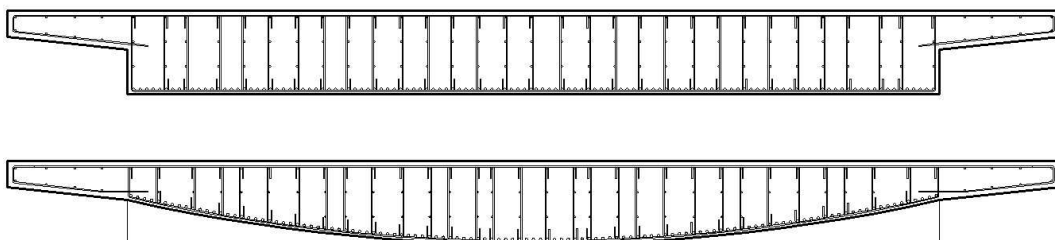
Slika 6.3 – Raspored armature pločastog sklopa
