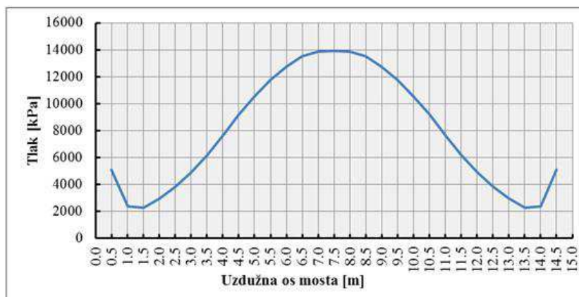
Slika 6.27 – Raspodjela tlaka eksplozije po duljini rasponskog sklopa mosta Tip 1
