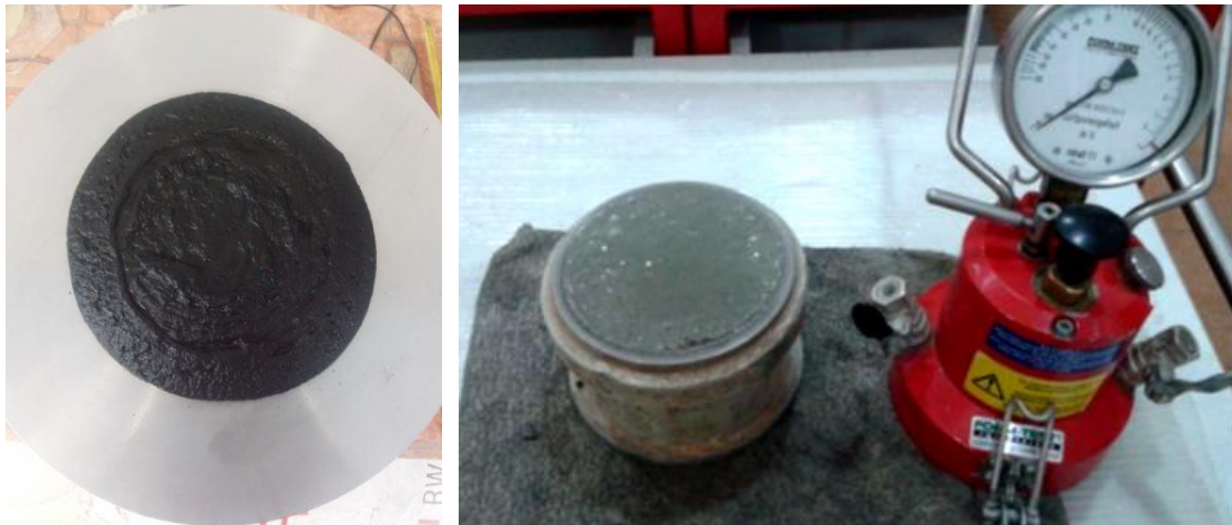
Slika 6.11: Određivanje konzistencije stolićem za potresanje te gustoće i udjela pora svježega morta pomoću porometra
