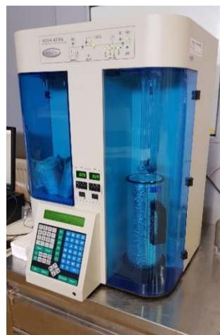
Slika 6.10: Ispitivanje specifične površine BET metodom
