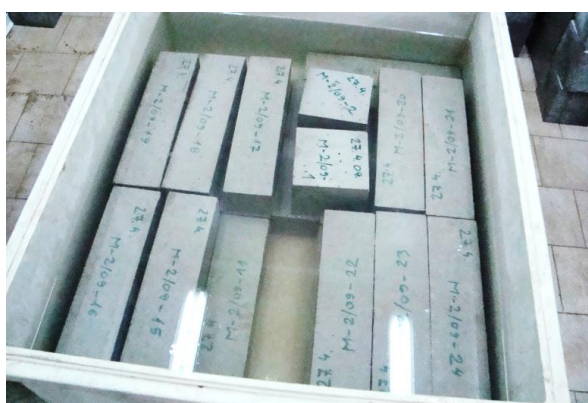
Slika 6.18: Njega uzoraka betona pod vodom
