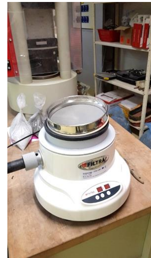
Slika 6.8: Prosijavanje na sitima sijačicom zračnim mlazom
