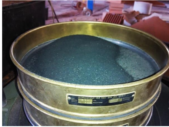
Slika 6.4: Prosijavanje pepela na situ veličine otvora 1 mm
