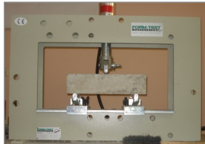
Slika 5. 18: Ispitivanje vlačne čvrstoće savijanjem
