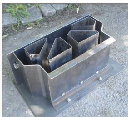
Slika 6.1: Izgled kalupa za izradu blokova
