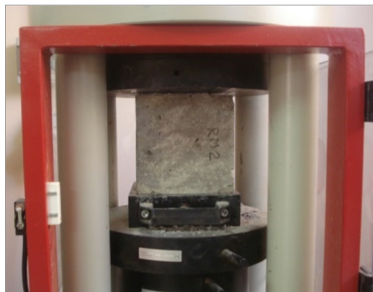
Slika 5. 17: Tlačna čvrstoća na kocki brida 10 cm
