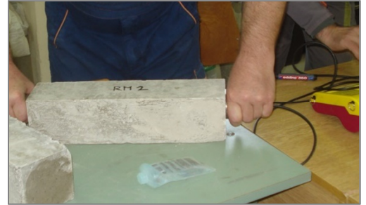
Slika 5. 16: Ispitivanje brzine prolaza ultrazvuka
