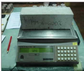
Slika 5. 15: Mjerenje mase uzoraka
