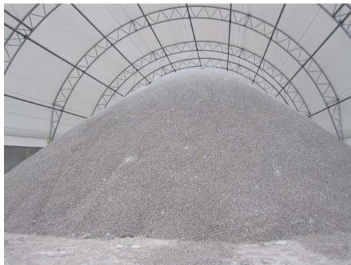
Slika 15. Natkrivena deponija mineralne mješavine [118]
