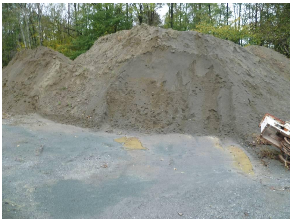
Slika 82. Deponija kamenog agregata na asfaltnom postrojenju u Lužanima
