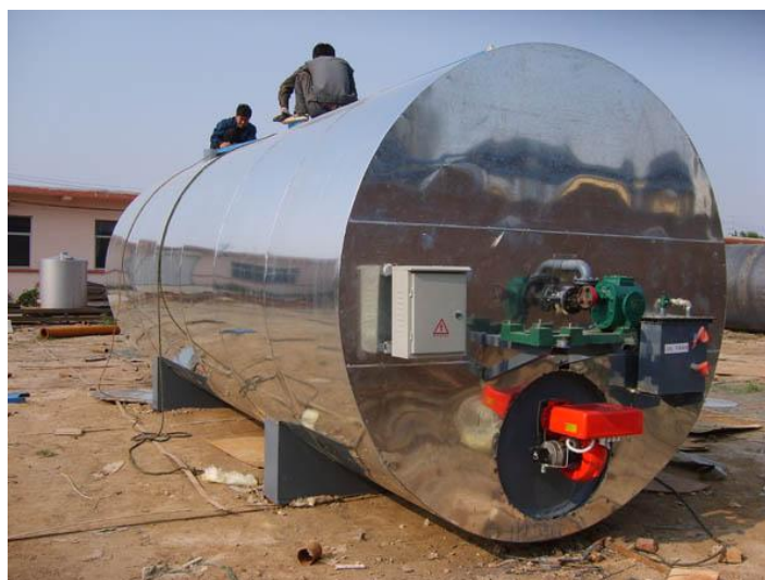
Slika 27. Spremnik za bitumen [129]
