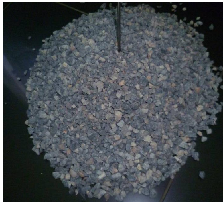
Slika 210. Ispitani uzorak kamene frakcije granulacije 4/8 mm
