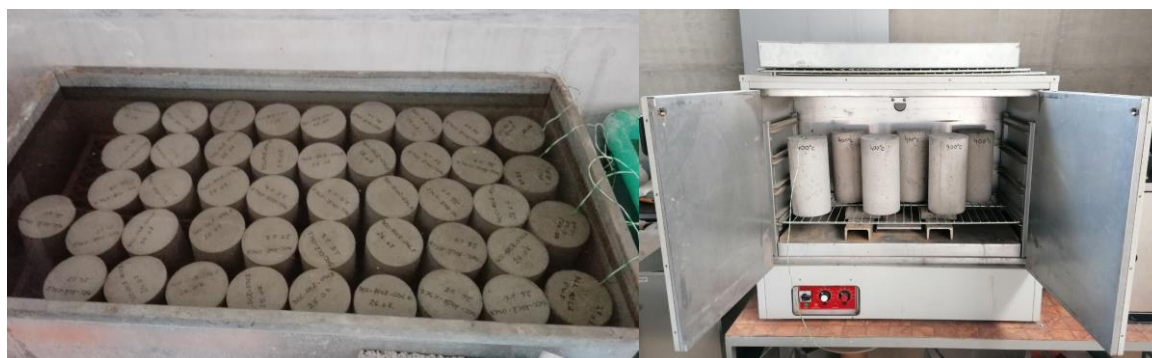
Slika 6.11 Njega betonskih uzoraka u vodi i sušenje betonskih uzoraka u sušioniku
