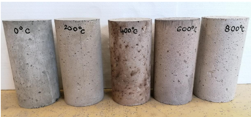
Slika 6.32 Promjena boje uzoraka betonske mješavine SCC-15CR-5SLF
