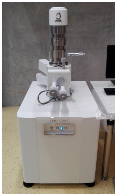
Slika 6.58 Pretražni elektronski mikroskop JEOL SEM JSM-IT200
