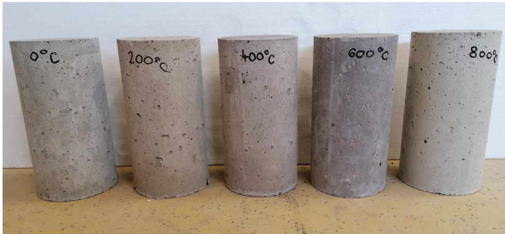
Slika 6.31 Promjena boje uzoraka betonske mješavine SCC-10CR-0SLF
