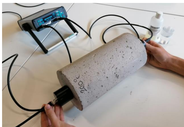
Slika 6.35 Mjerenje brzine prolaska ultrazvučnog impulsa na betonskim uzorcima valjaka
