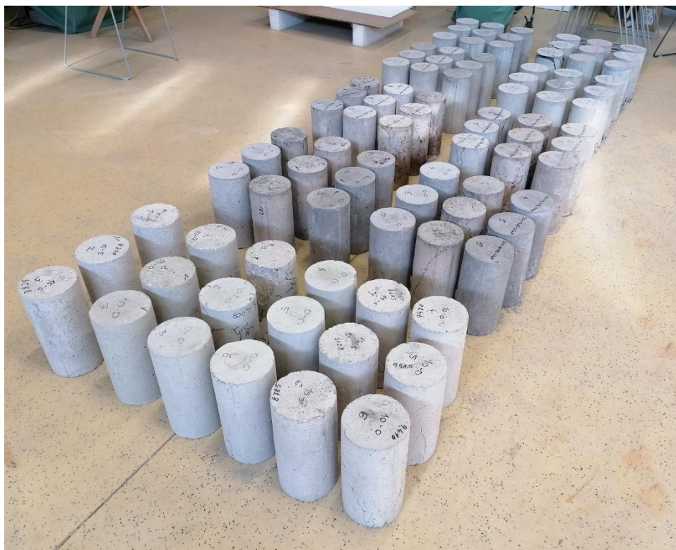
Slika 6.29 Promjena boje ispitanih betonskih uzoraka
