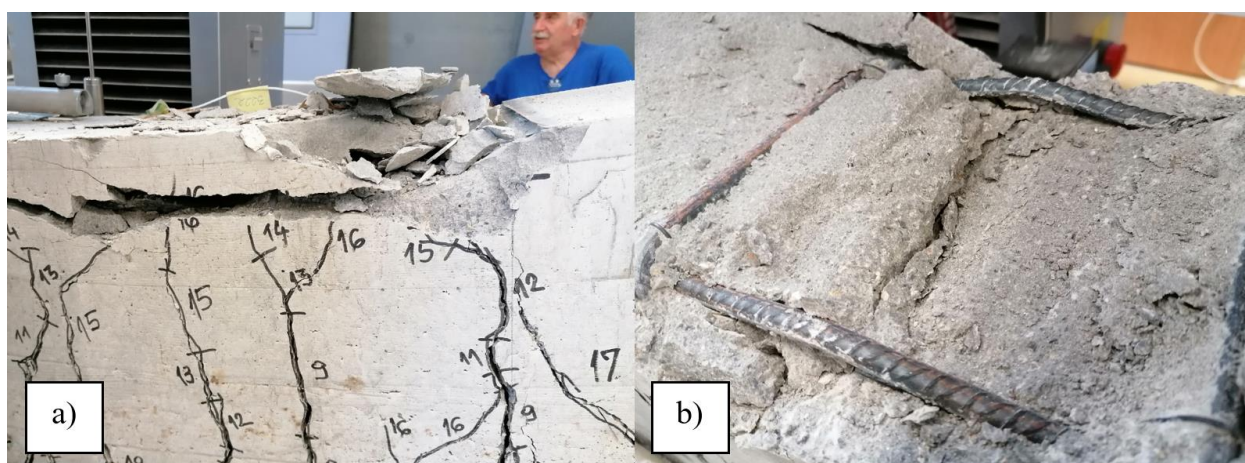
Slika 7.51 Detalji sloma grede SCC-R-G2: (a) slom betona u tlačnoj zoni; (b) lokalno izvijanje armature u tlačnoj zoni
