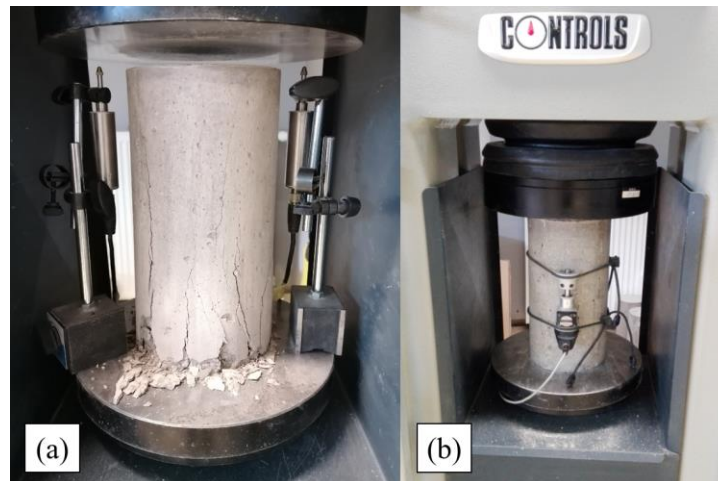
Slika 6.37 Ispitivanje mehaničkih svojstava betonskih uzoraka: (a) tlačna čvrstoća i odnos naprezanje-deformacija (LVDT-i); (b) modul elastičnosti (ekstenzometri)
