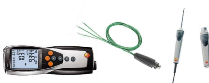
Slika 4.15 Uređaj Testo 435-4, sonda s trostrukim sustavom senzora za mjerenje temperature površine zida ( T_w ) i senzorom na priključku sonde za određivanje unutarnje temperature zraka ( T_i ) te bežična sonda za određivanje vanjske temperature zraka ( T_e ) [201]
