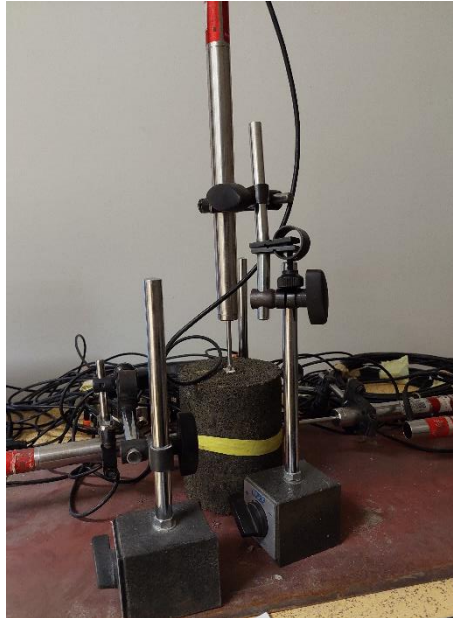
Slika 3.19. Mjerenje skupljanja uzorka
