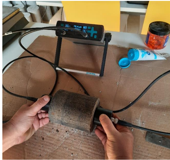
Slika 3.13. Mjerenje brzine ultrazvučnog impulsa
