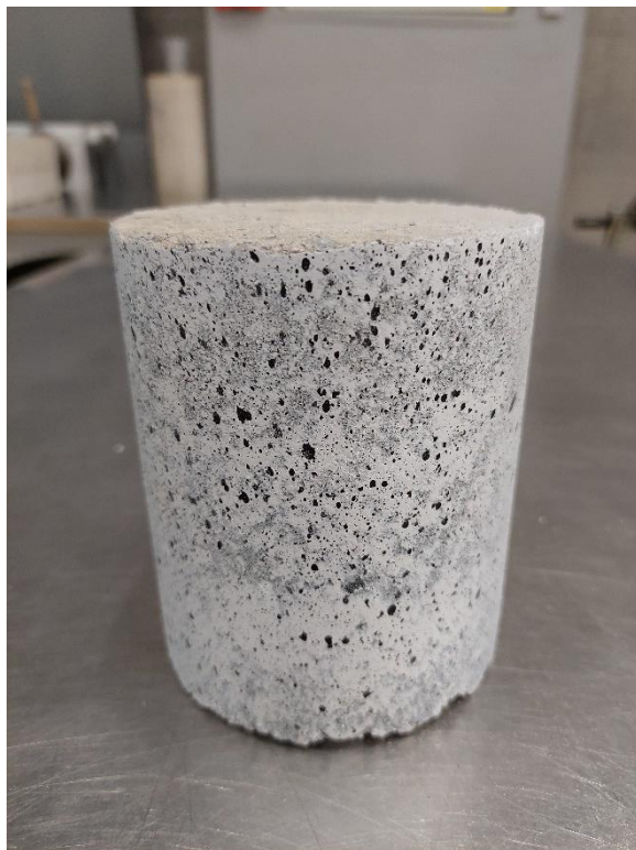
Slika 3.15. Uzorak pripremljen za ispitivanje statičkog modula elastičnosti
