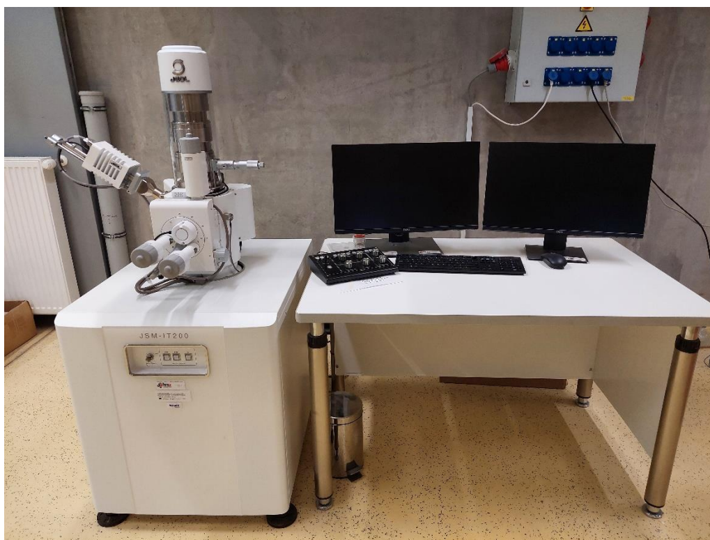
Slika 3.17. Pretražni elektronski mikroskop (eng. Scanning Electrone Microscope – SEM)
