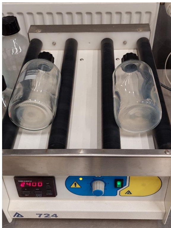
Slika 3.16. Postupak pripreme eluata
