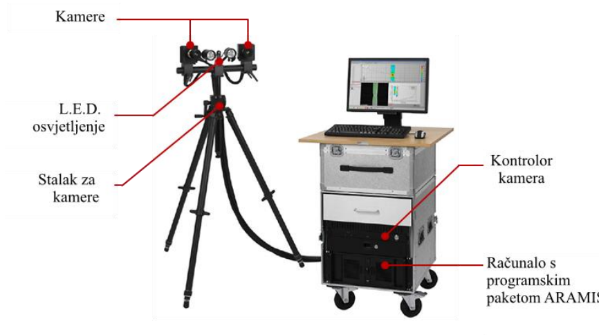
Slika 3.14. Sustav GOM ARAMIS za digitalnu stereo fotogrametriju
