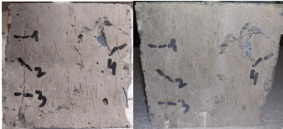
Slika 6.68. Mješavina M1 nakon smrzavanja i odmrzavanja (lijevo – prije samocijeljenja, desno - nakon samocijeljenja)
