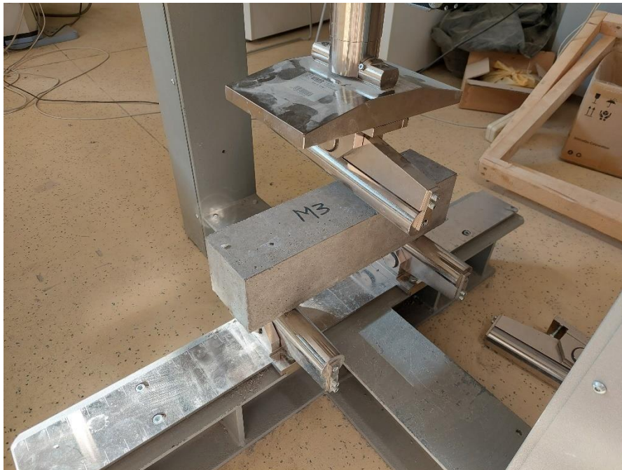
Slika 6.46. Ispitivanje vlačne čvrstoće betona savijanjem
