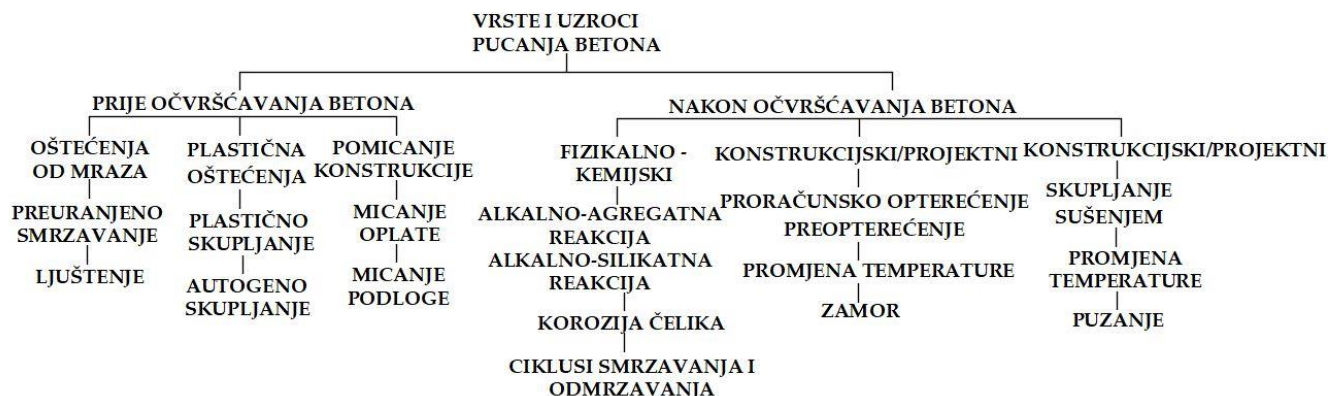
Slika 1.2. Uobičajeni uzroci pojava pukotina u betonu [2]
