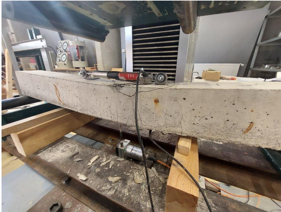
Slika 7.23. Izgled grede nakon sloma uslijed čistog savijanja
