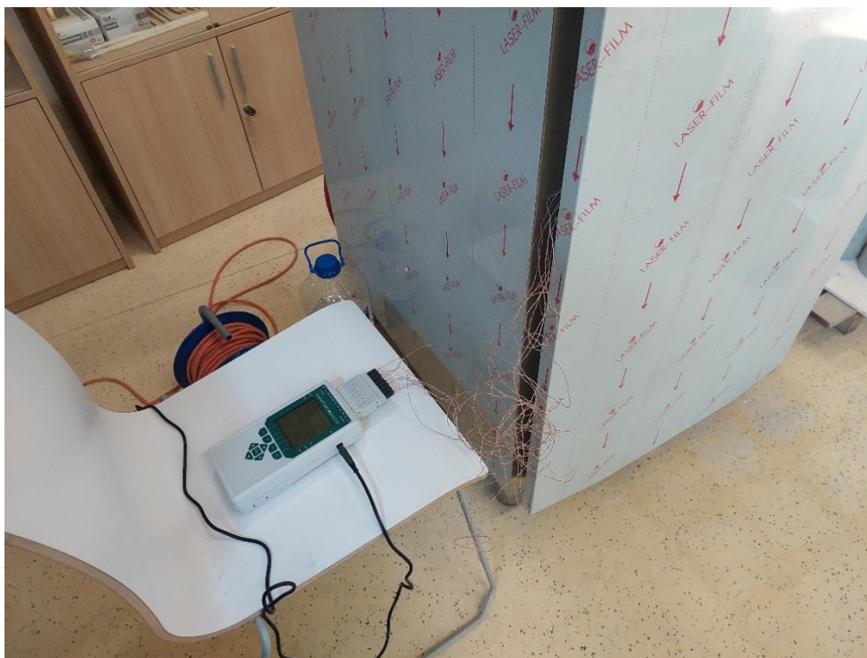
Slika 6.23. Termoparovi iz kocaka betona u klima komori spojeni na uređaj za prikupljanje podataka
