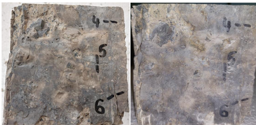
Slika 6.78. Mješavina M6 nakon smrzavanja i odmrzavanja (lijevo – prije samocijeljenja, desno - nakon samocijeljenja)
