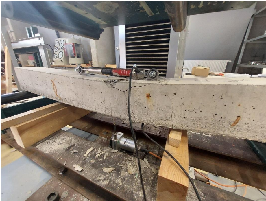
Slika 7.23. Izgled grede nakon sloma uslijed čistog savijanja
