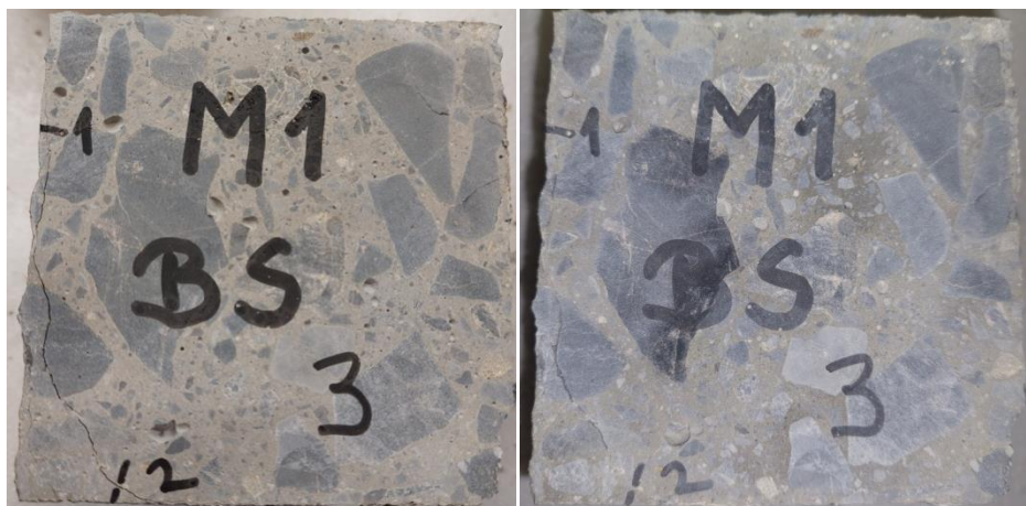
Slika 6.67. Mješavina M1 bez smrzavanja (lijevo – prije samocijeljenja, desno - nakon samocijeljenja)
