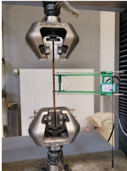
Slika 7.5. Ispitivanje poprečne armature na kidalici Shimadzu
