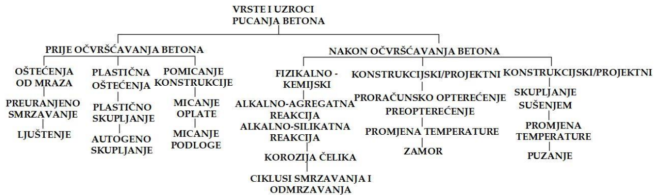
Slika 1.2. Uobičajeni uzroci pojava pukotina u betonu [2]
