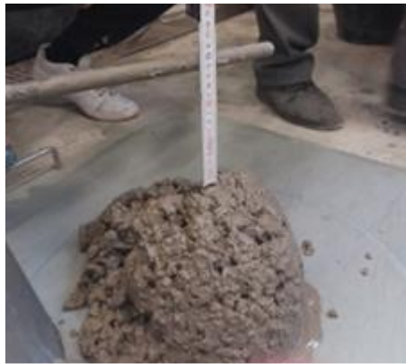
Slika 6.18. Određivanje konzistencije betona slijeganjem
