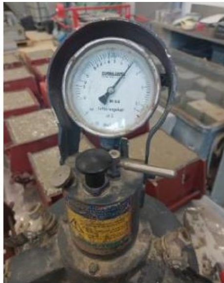
Slika 6.19. Određivanje udjela pora u betonu
