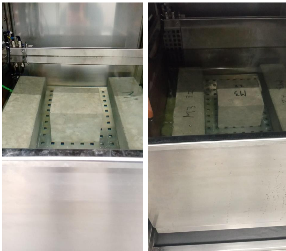
Slika 6.39. Kocke i prizme u komori za ispitivanje betona na cikluse smrzavanja i odmrzavanja
