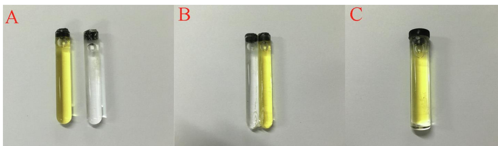
Slika 4.24. Tri različite vrste kapsula (A: tip A: dvostruka kapsula paralelnog stila; B: tip B: dvostruka kapsula u kontaktu s tijelom; C: tip C: koncentrična kapsula) [82]
