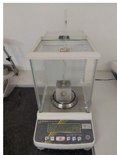
Slika 6.3. Priprema uzoraka za ispitivanje specifične površine
