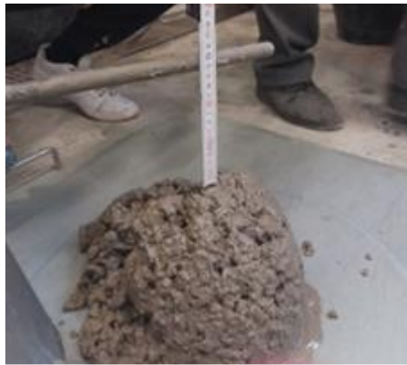
Slika 6.18. Određivanje konzistencije betona slijeganjem
