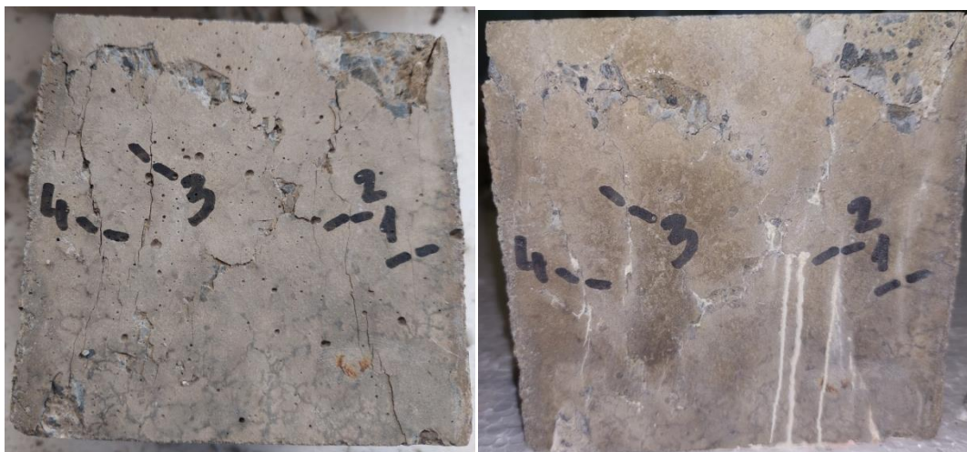
Slika 6.77. Mješavina M6 bez smrzavanja (lijevo – prije samocijeljenja, desno - nakon samocijeljenja)
