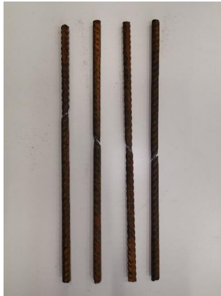
Slika 7.7. Ispitani uzorci uzdužne amature
