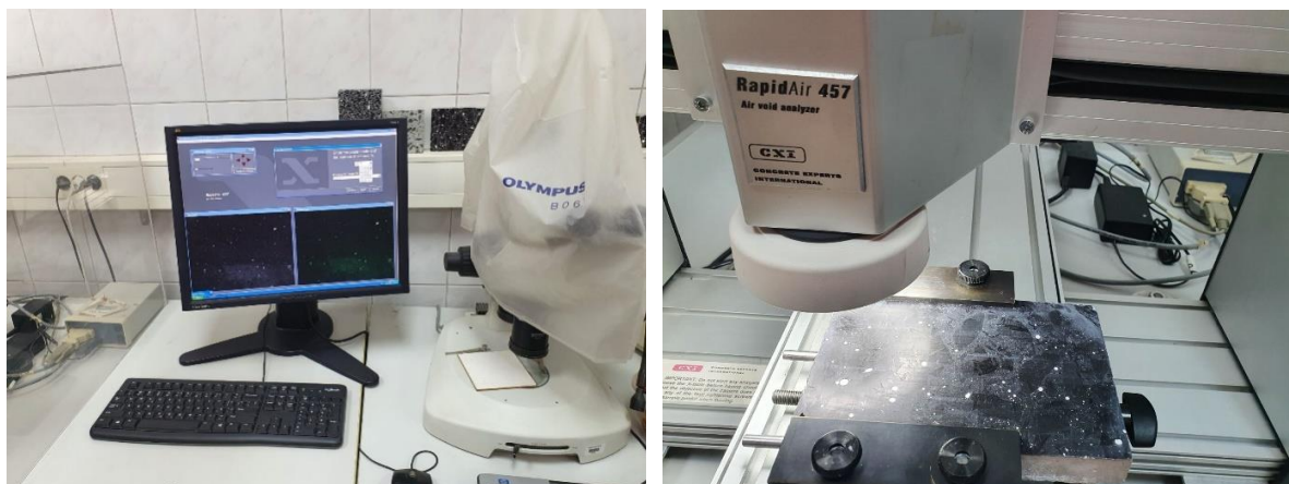
Slika 6.37. Uređaj za određivanje faktora razmaka pora – Rapid Air 457
