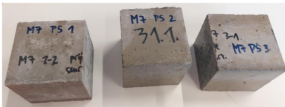
Slika 6.63. Betonske kocke mješavine M7 dimenzija 10 x 10 cm
