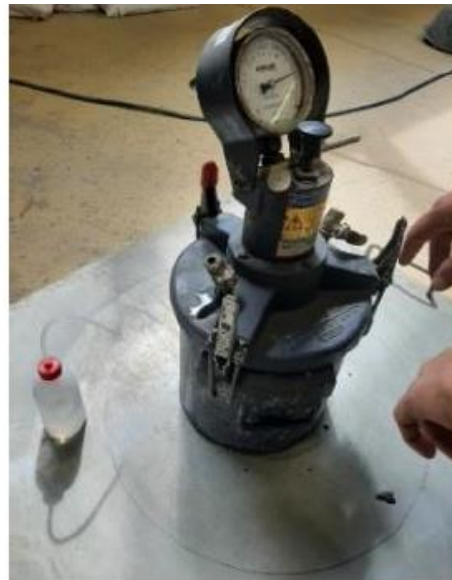
Slika 6.19. Određivanje udjela pora u betonu
