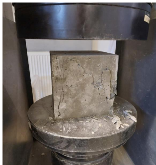
Slika 7.4. Ispitivanje tlačne čvrstoće betona
