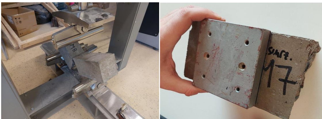
Slika 6.62. Ispitivanje betonske prizme na vlak savijanjem (lijevo), priprema betonskih prizmi nakon ispitivanja na vlak savijanjem za izrezivanje kocaka 10 x 10 x 10 cm (desno)
