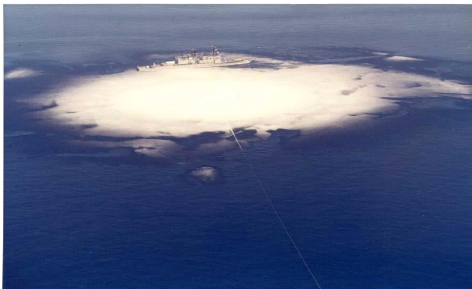
Slika 3.19 Područje kavitacije podvodne eksplozije ograničene slobodnom površinom vode [20]
