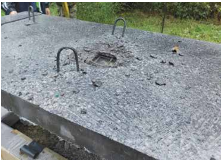
Ploča ispitana na proboj (lijevo) i statičko ispitivanje ploče (desno)
