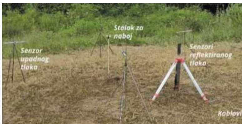
Postav instrumentata za prvu fazu eksperimenta (lijevo) i vatrena kugla (engl. blast fireball) nakon detonacije (desno)
