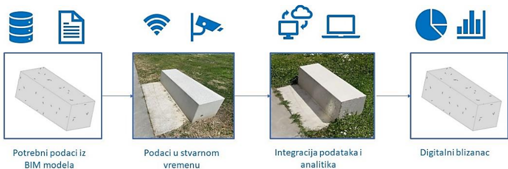
Slika 1. Proces stvaranja digitalnog blizanca izgradnje s BIM modelom
