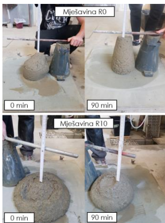
Slika 1. Ispitivanje betona u svježem stanju (konzistencija slijeganjem)
