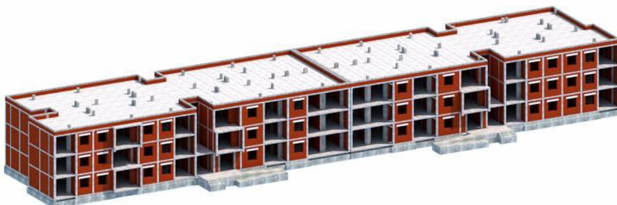
Slika 1. Informacijski model konstrukcije višestambene zgrade
