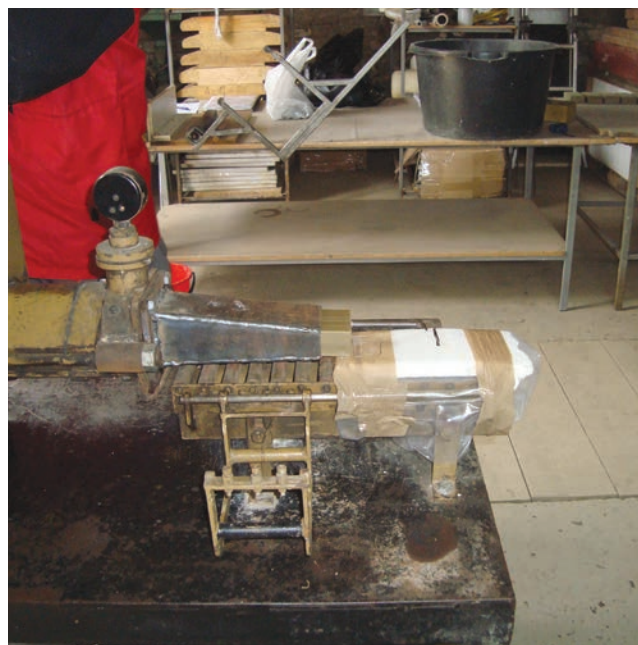
Slika 3. Strojna izrada opeka
