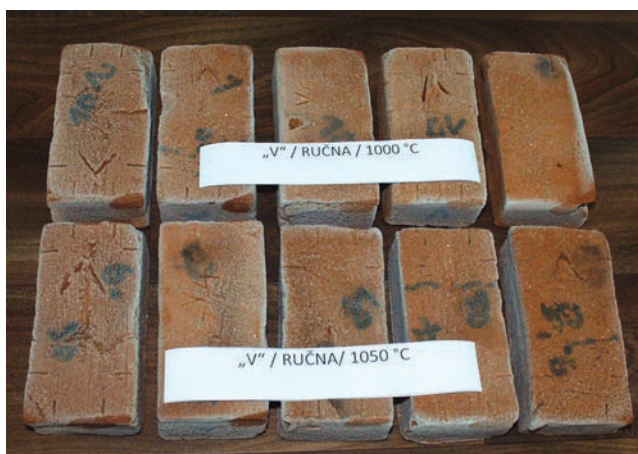
Slika 9. Izgled ručno izrađene opeke "V" nakon izlaganja ciklusima smrzavanja/odmrzavanja
