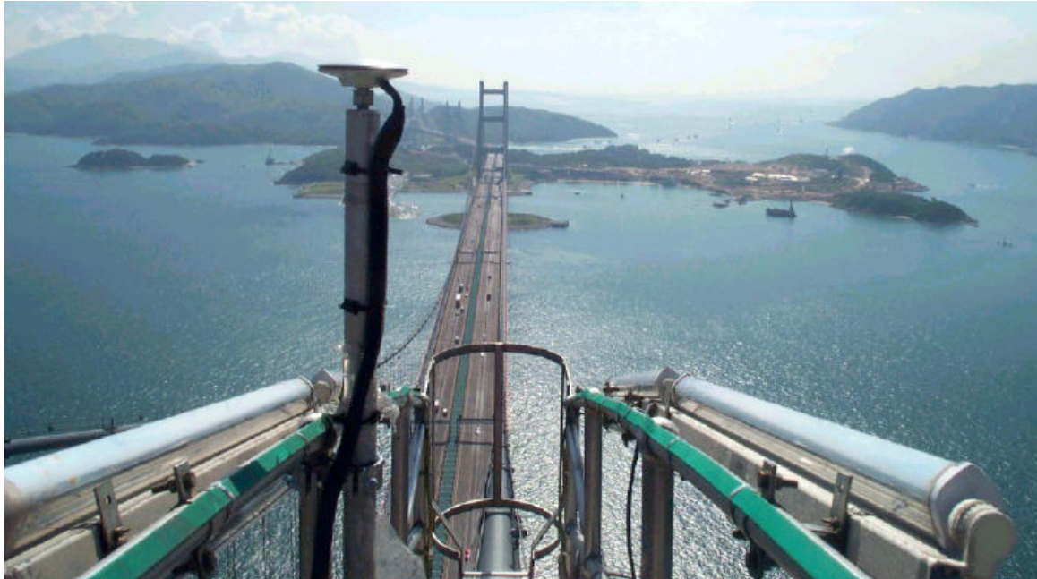
Slika 6 – GPS antena na vrhu pilona
