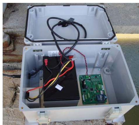
Slika 13 – Akcelerometar u zaštitnoj kutiji, prijenos podataka bežičan
