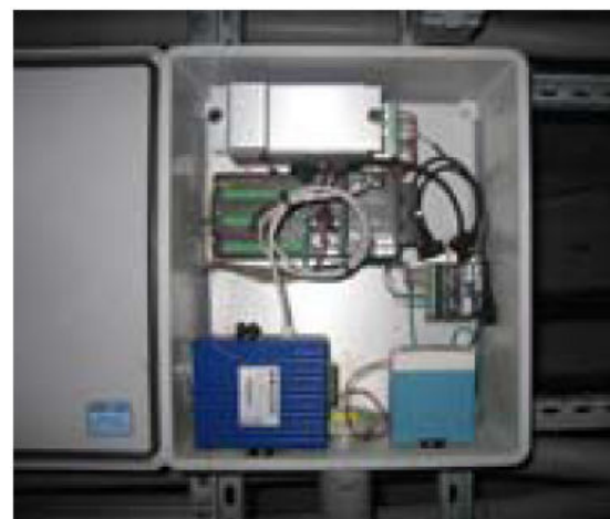
Slika 20 – Temperaturni senzor i uređaj za prikupljanje podataka s vibrožice
