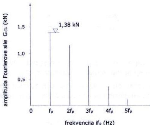
Slika 6 - Diskretni Fourierov spektar za dinamičku силу prikazanu na slici 5 [2]
