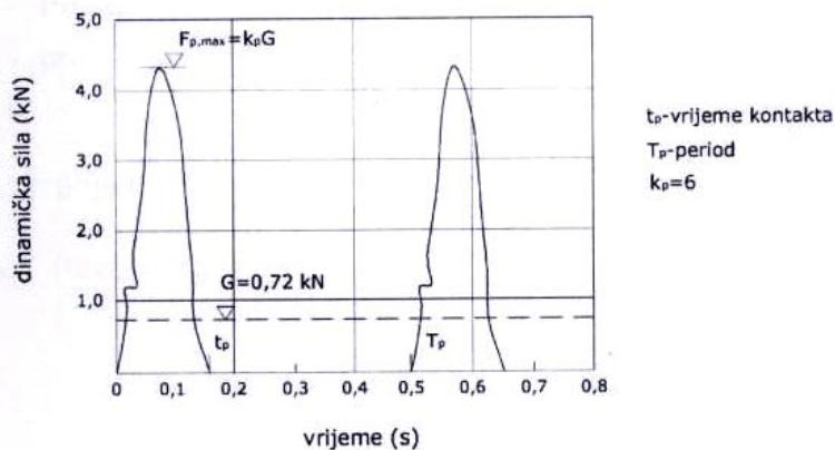
Slika 5 - Primjer funkcije dinamičke sile zbog skakanja na mjestu s obje noge istovremeno,  $f = 2 \text{ Hz}$  [2]
