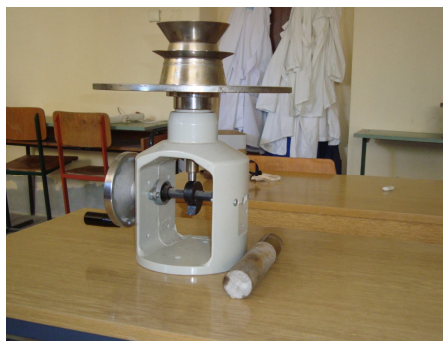
Slika 3 - Potresni stolić za određivanje konzistencije mortova
