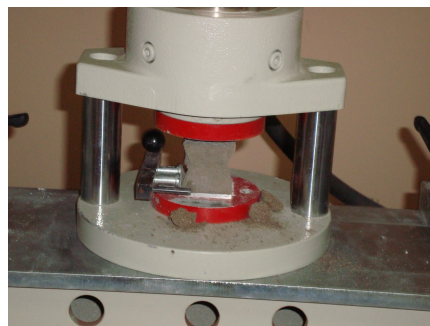
Slika 8 - Ispitivanje tlačne čvrstoće morta
