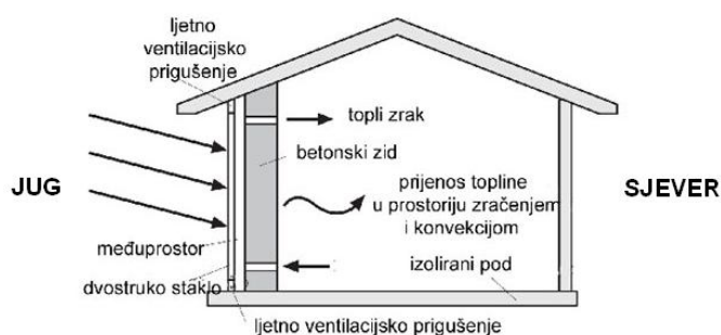
Slika 9 - Trombov zid
