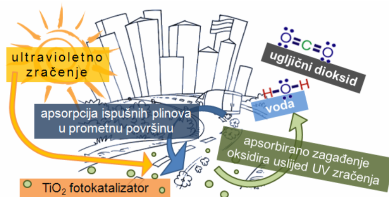
Slika 6 - Fotokatalitički proces na prometnim površinama premazanim titanovim dioksidom, [17] (sliku uredili autori)
