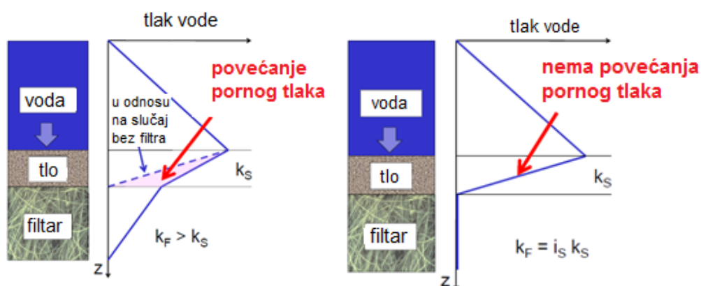
Slika 11 - Povećanje pornog tlaka zbog nedovoljne propusnosti filtra (lijevo) i nepostojanje porasta pornog tlaka kada je propusnost filtra dovoljna (desno) [6]
