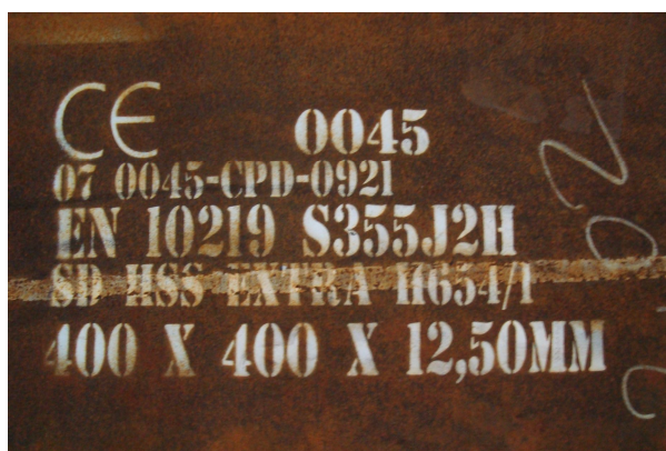
Slika 2 – Oznaka kvalitete čelika za proizvodnju nosača
