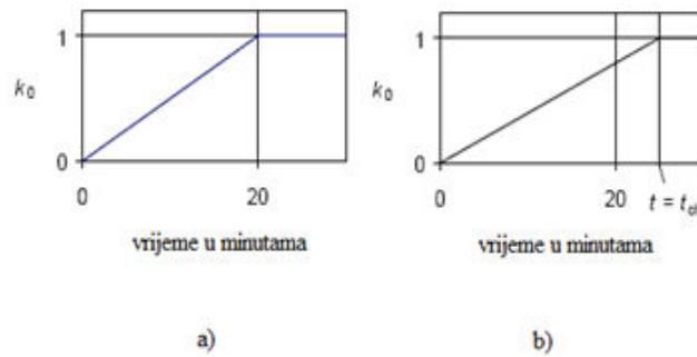
**Slika 4 – Varijacije faktora  $k_0$  za a) nezaštićene elemente i zaštićene elemente kada je  $t_{ch} \leq 20$  min, i za b) zaštićene elemente kada je  $t_{ch} > 20$  min**
