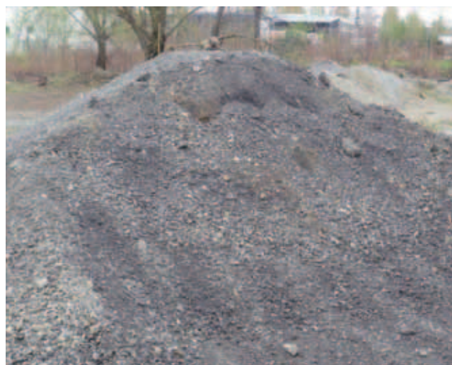
Slika 1. Deponirani reciklirani asfalt
