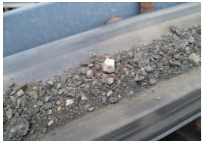
Slika 7. Reciklirani asfalt dobiven glodanjem bitumeniziranog nosivog sloja
