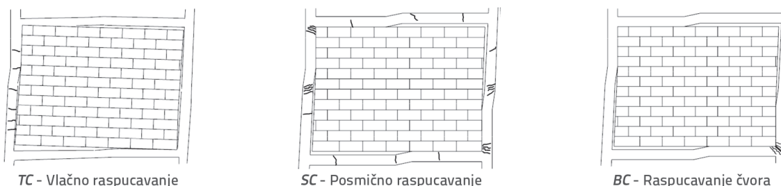
Slika 4. Mehanizmi oštećenja armiranobetonskog okvira, [32]
