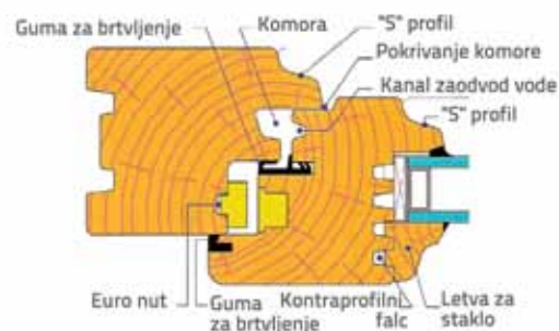
Slika 13. Detalj drvenog prozora s IZO staklima
