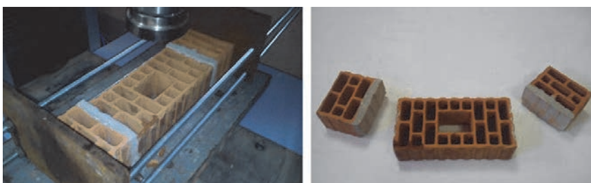
Slika 4. Posmični slom klizanjem po vertikalnim sljubnicama morta
