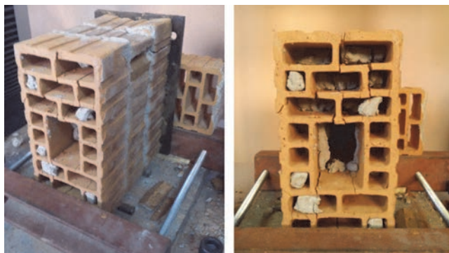
Slika 6. Vlačni lom zidnog elementa pri posmiku kao posljedica prodiranja morta u šupljine
