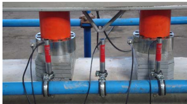
Slika 7. Mjerenje pomaka grede pri unosu opterećenja
