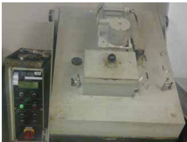
Slika 2. Laboratorijska miješalica za asfalt
