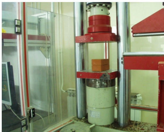
Slika 3.11 Određivanje tlačne čvrstoće u preši
