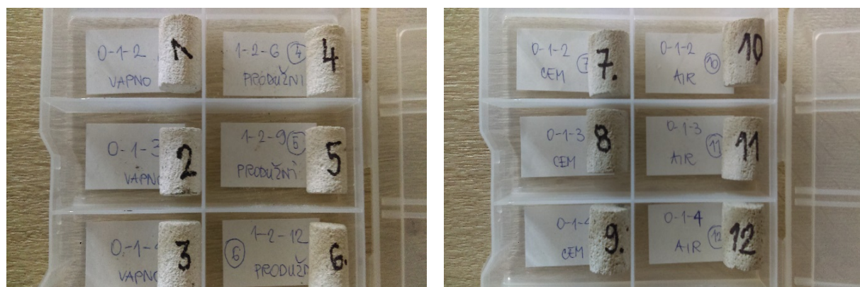
Slika 5.34. Izgled uzoraka morta za ispitivanje na živinom porozimetru
