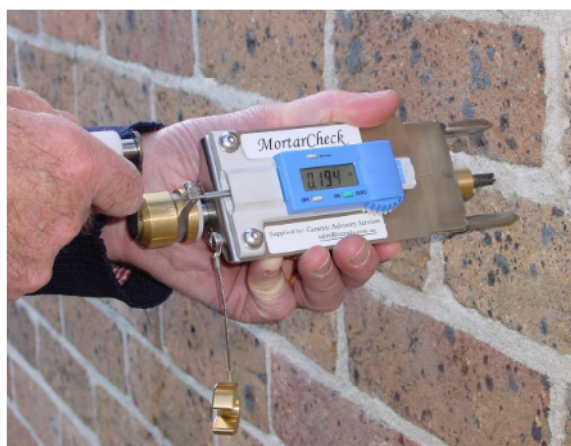
Slika 4.7 Mjerenje indeksa abrazije in situ [186, 187, 189]
