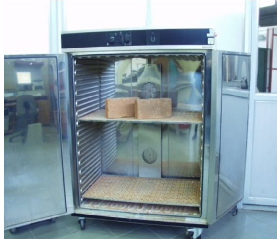
Slika 3.8 Sušenje uzoraka u sušioniku
