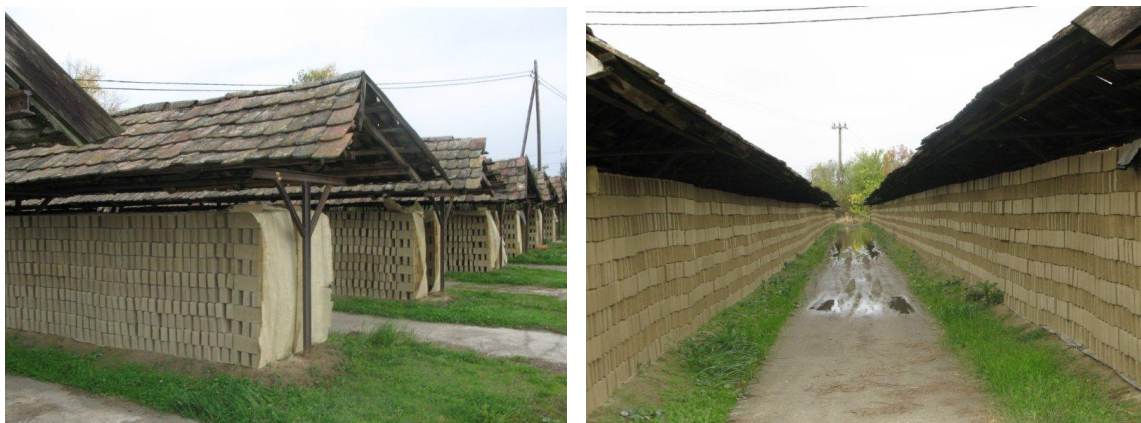
Slika 3.16 Primjer sušenja pune opeke u natkrivenoj sušari prirodnim putem
