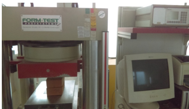
Slika 5.21. Određivanje tlačne čvrstoće zidnih elemenata
