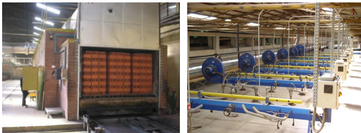
a) b) Slika 3.23 Pogon Našice: a) tunelska peć; b) stropni plamenici
