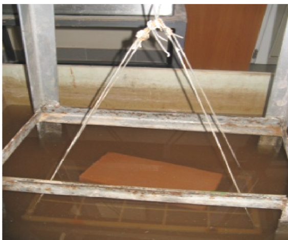
Slika 3.6 Hidrostatsko vaganje opeke
