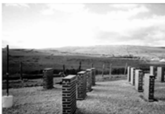
Slika 4.6 Ispitivanje zidnih panela na terenu [184]
