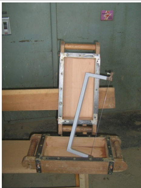
Slika 3.15 Drveni kalup za oblikovanje ručno proizvedene opeke
