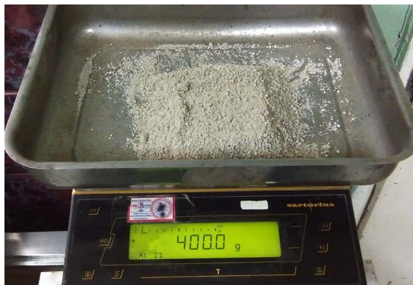
Slika 6-9: Određivanje mase uzorka prije ispitivanja vaganjem
