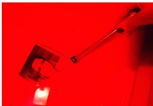
Slika 8. Utvrđivanje optimalne ekspozicije fotografskog papira
