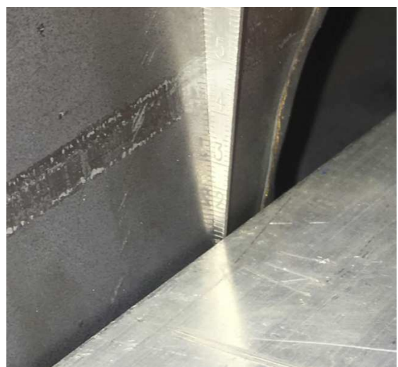
Slika 7. Stub zavaren u konstruisanom alatu
