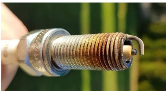
Slika 7. Stanje elektroda svjećice
