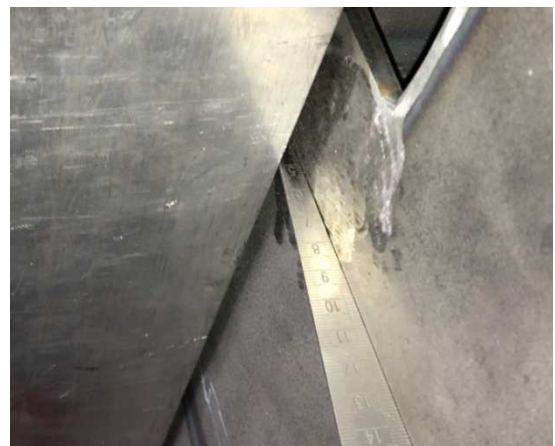
Slika 6. Stub zavaren izvan alata
