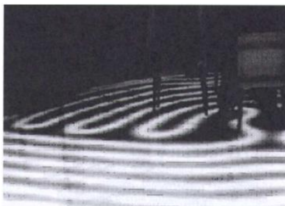
Slika 2. Tremogram dijagnoze oštećenja podnog grijanja [7]
