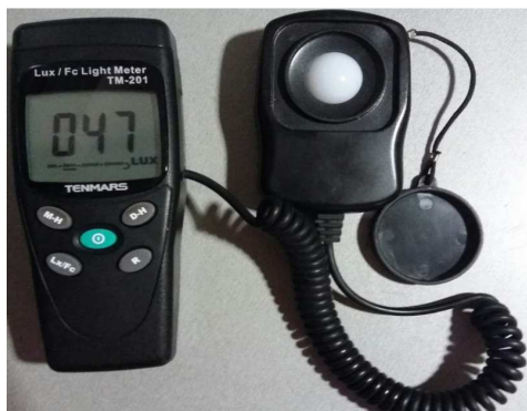
Slika 1. Mjerni instrument TENMARS Lux/Fc Light Meter TM-201
