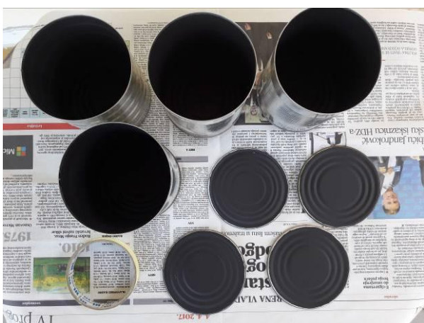
Slika 18. Bojanje unutrašnjosti kamere crnom mat bojom
