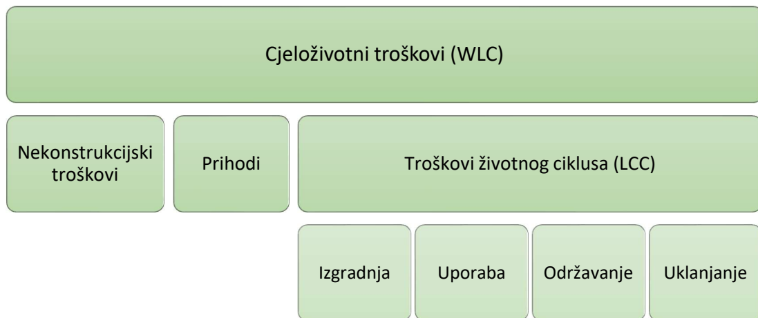
Slika 3. Strukturalna raščlamba troškova građevine (Krstić, 2011.)
