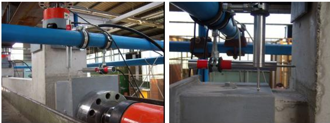
Slika 4.14 Prikaz horizontalnih i vertikalnih LVDT_a za mjerenje pomaka
