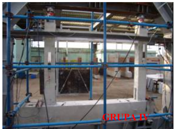
Slika 4.19 Prikaz mjernih instrumenata na modelima (GRUPAMA)
