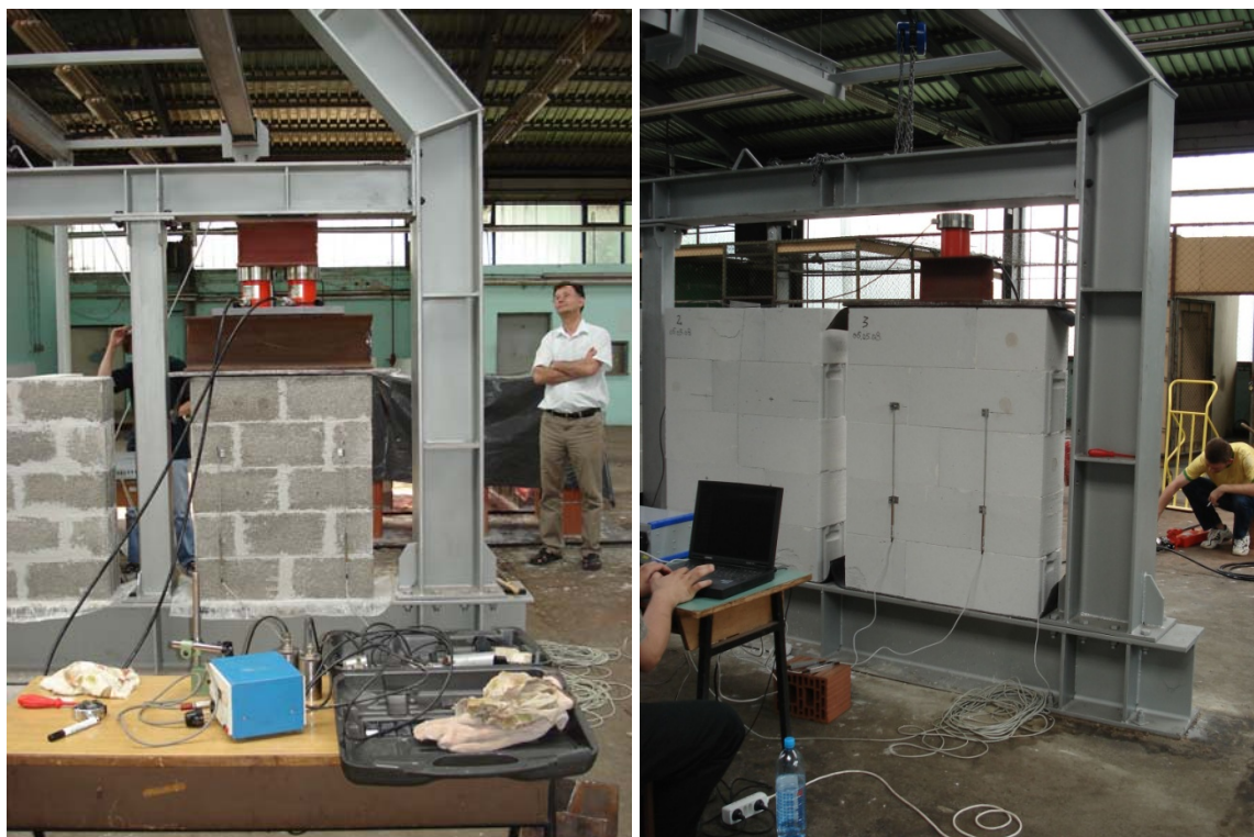
Slika 3.9 Ispitivanje tlačne čvrstoće zidnog ispuna od betonskog bloka i ytonga
