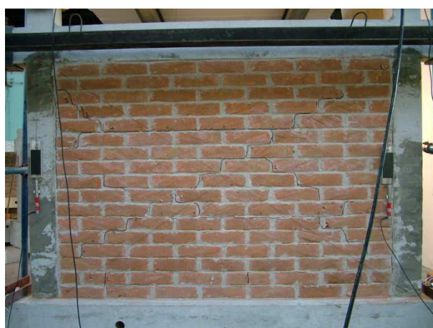
Slika 6.59 Prve značajne pukotine u ispuni ispitnog uzorka O1_cvm
