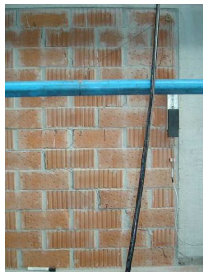
Slika 6.50 Prikaz prvih pukotina ispitnog uzorka O1_bvm
