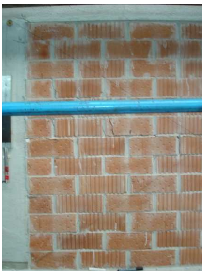
Slika 6.50 Prikaz prvih pukotina ispitnog uzorka O1_bvm
