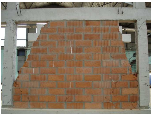
Slika 6.26 Prikaz oštećenja i pukotina ispitnog uzorka O1_bpm
