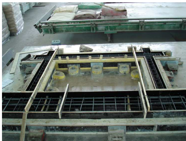
Slika 3.4 Detalji armiranja i geometrijskih izmjera ispitnih uzoraka skupine O4
