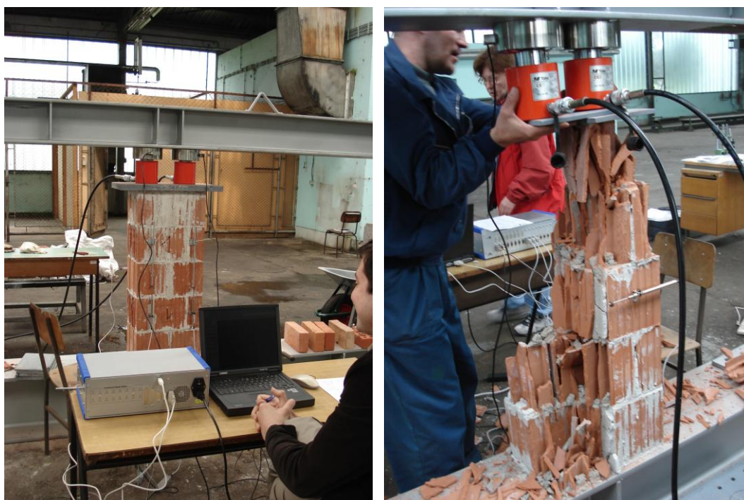
Slika 3.4. Ispitivanje tlačne čvrstoće zida
