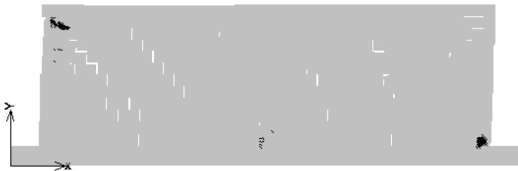
Slika 5.32. Slika deformacija i pukotina većih od 0,1mm pri relativnom katnom pomaku od 0,5.% (hor. pomaci povećani 10 puta) model zida F
