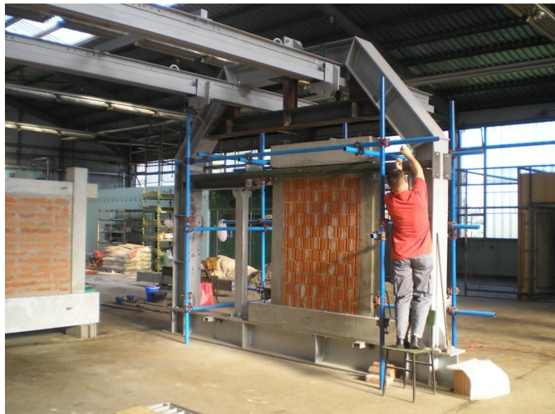
Slika 4.7. Prikaz gotovog uzorka u okviru za ispitivanje
