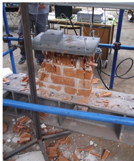
Slika 2.17. Zidna prizma uslijed ispitivanja na tlaku vertikalnom smjeru (lijevo) te uzorak nakon sloma (desno)
