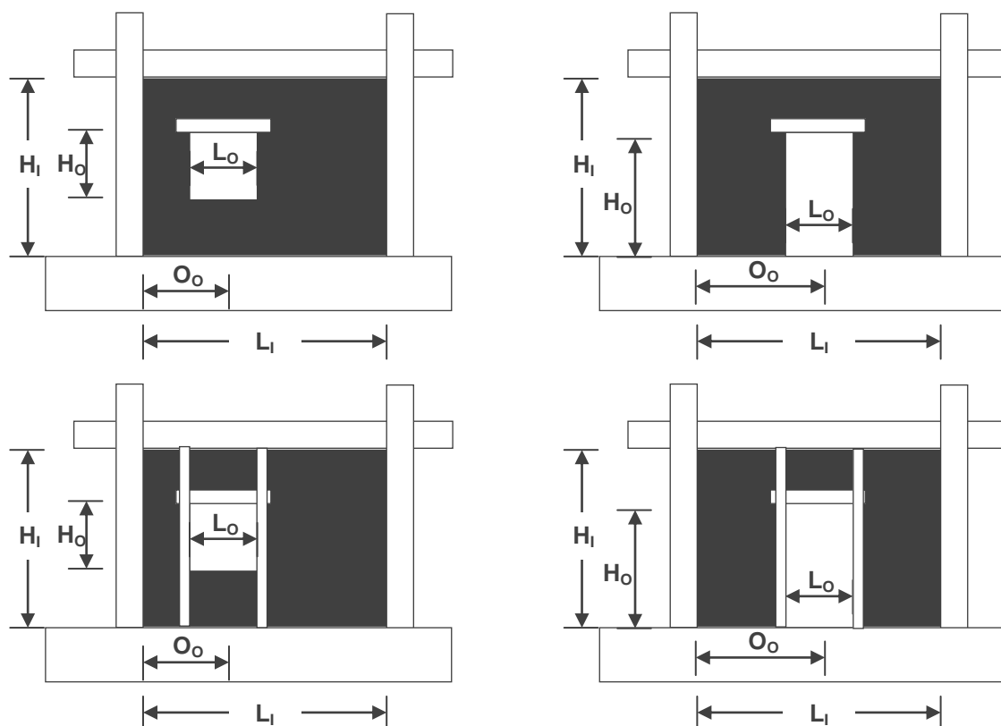
Slika 10.2. Otvor u ispunu s osnovnim izmjerama
