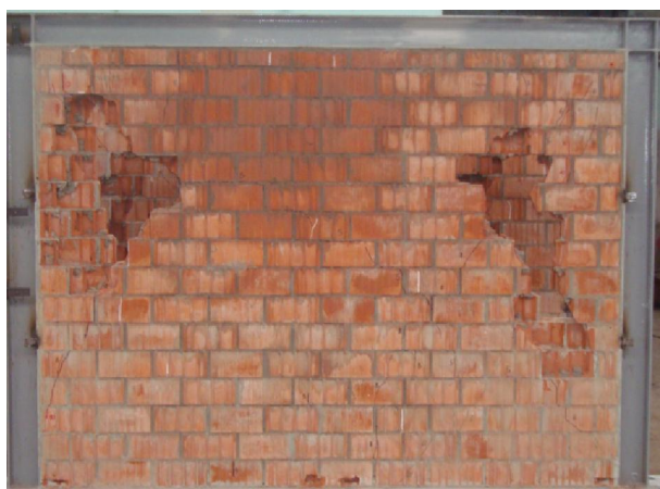
Slika 4.74 – Oštećenja okvira sa zidanim ispunom: a) okvir OG-3, b) okvir OY-1
