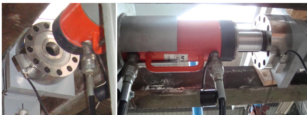
Slika 4.27 – Unošenje opterećenja u čelični okvir
