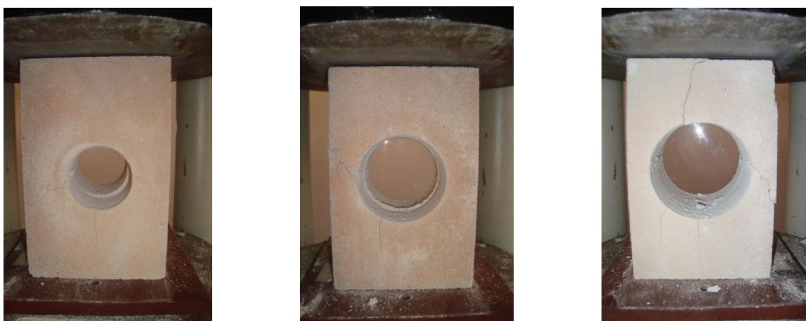
Slika 4.8– Ispitivanje izbušenih porobetonskih blokova
