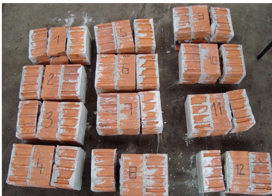
Slika 4.21 – Određivanje posmične čvrstoće – ispitani uzorci
