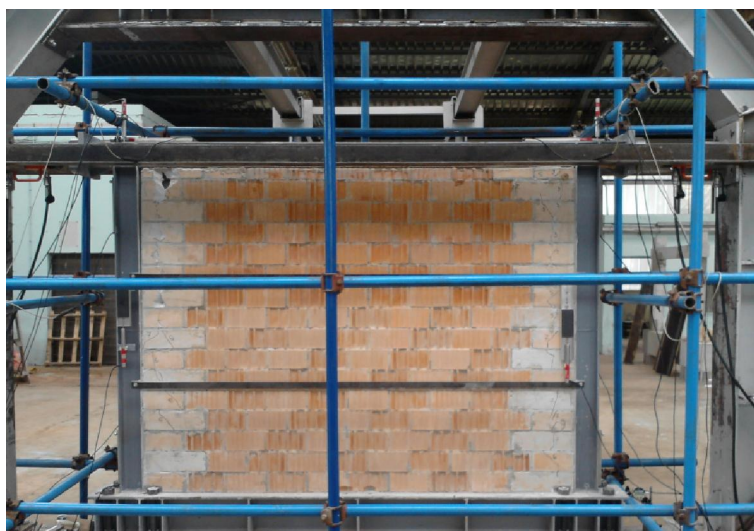
Slika 4.37 - Ispitivanje čeličnog okvira s kombiniranim ispunom od šupljih glinenih i porobetonskih blokova (OGY-i)
