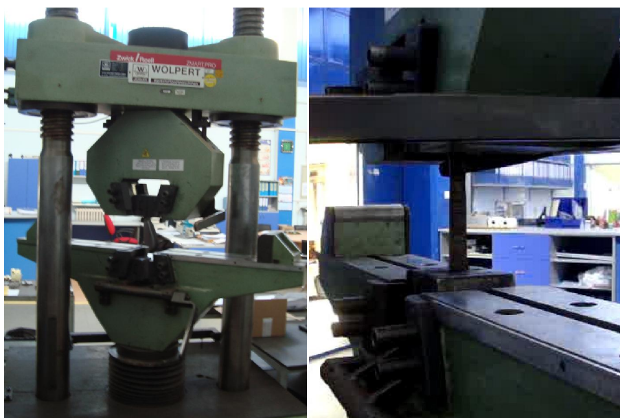
Slika 4.12 – Ispitivanje čeličnih epruveta
