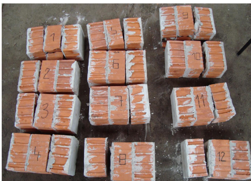
Slika 4.21 – Određivanje posmične čvrstoće – ispitani uzorci
