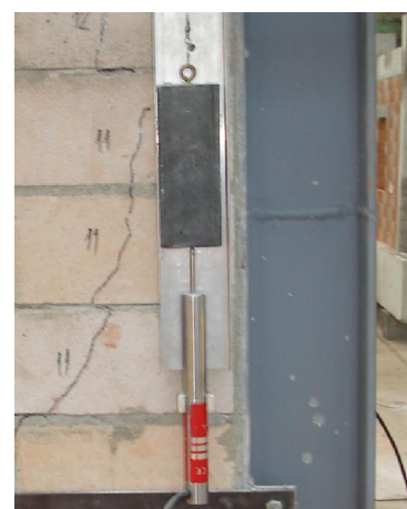
Slika 4.32 - Mjerenje produljenja/skraćenja dijagonala zidanog ispuna
