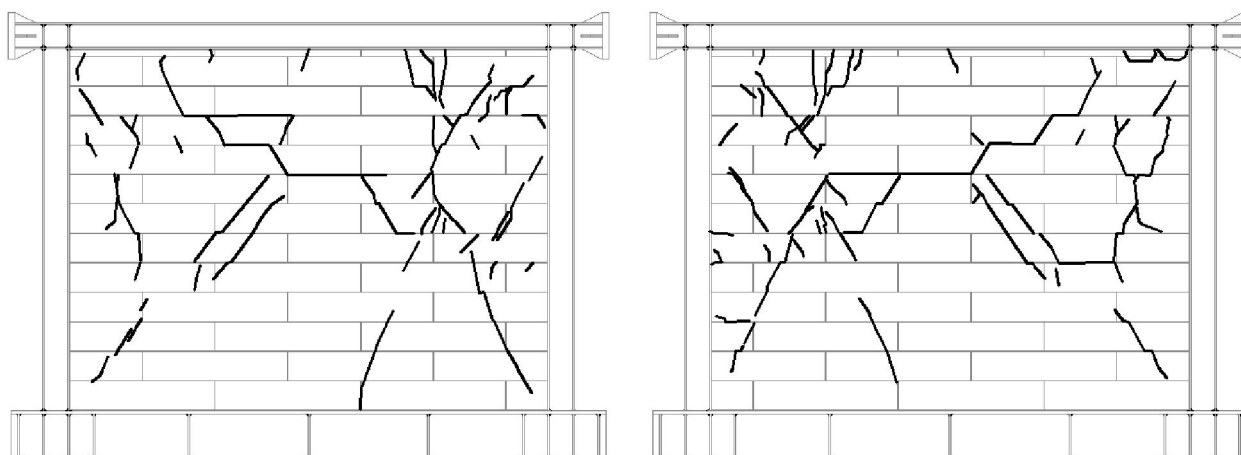
Slika 4.82 – Prikaz pukotina na prednjoj i stražnjoj strani okvira OY-1
