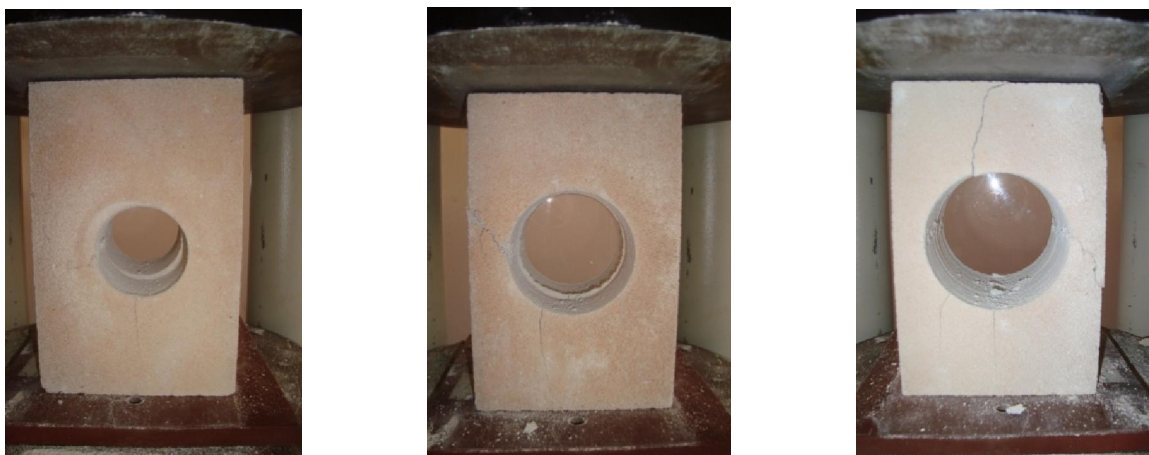
Slika 4.8– Ispitivanje izbušenih porobetonskih blokova
