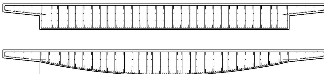
Slika 6.3 – Raspored armature pločastog sklopa
